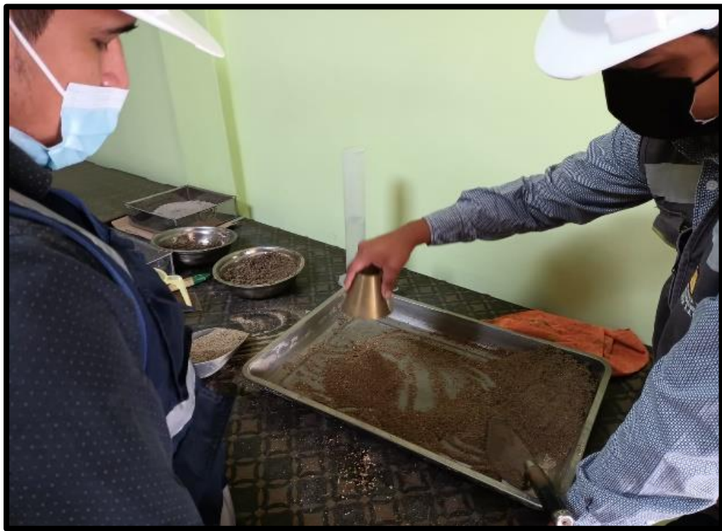
Figura 32: Retiro de molde
