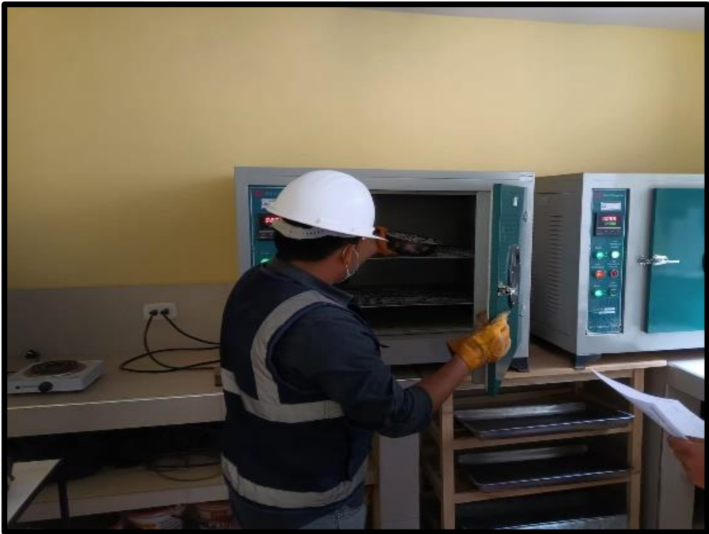
Figura 23: Colocación de muestra 110+/- 5°
