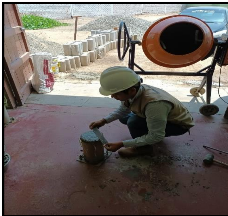
Figura 38: Enrasado de concreto en los moldes
