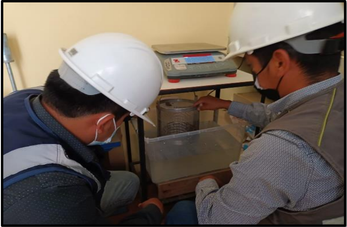
Figura 25: Muestra de Agregado Grueso sumergida en agua por 24 hrs.
