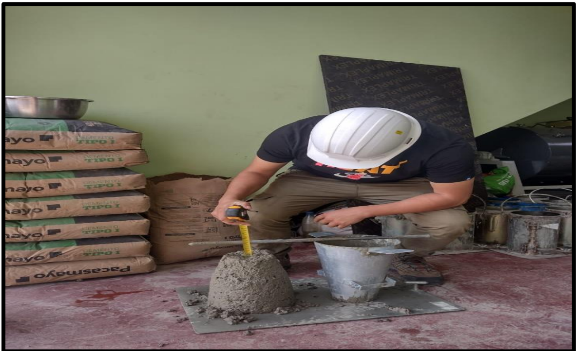
Figura 36: Retiro de muestra para determinar el asentamiento del concreto
