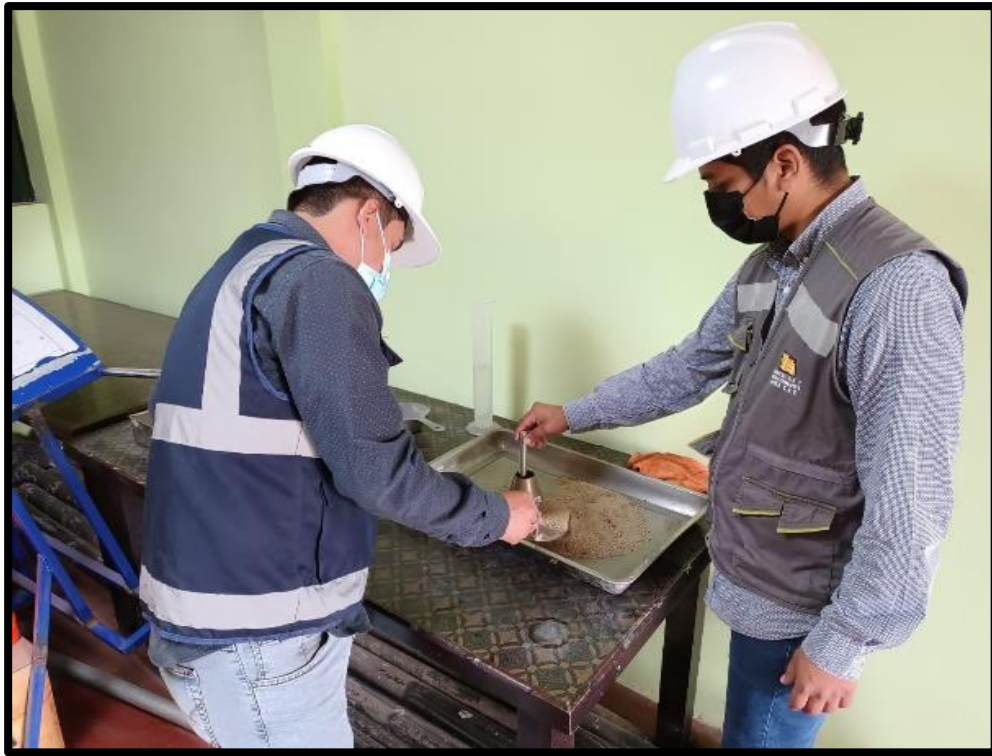
Figura 31: Compactación de muestra A. Fino
