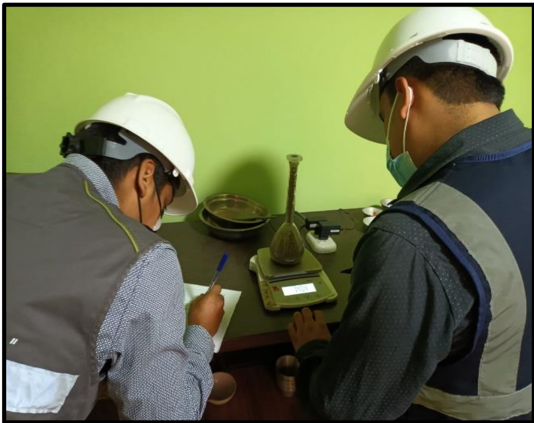
Figura 34: Peso de picnómetro + muestra + agua
