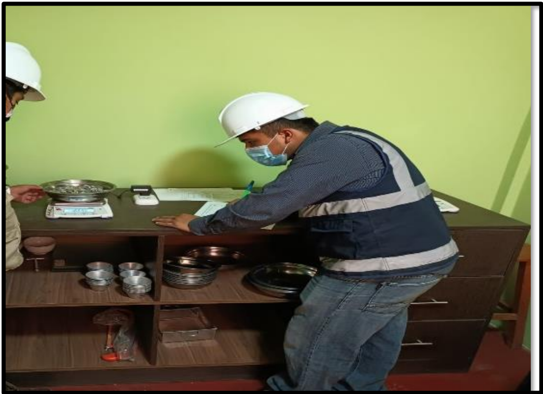
Figura 24: Pesado de muestra de A. Grueso después del horno
