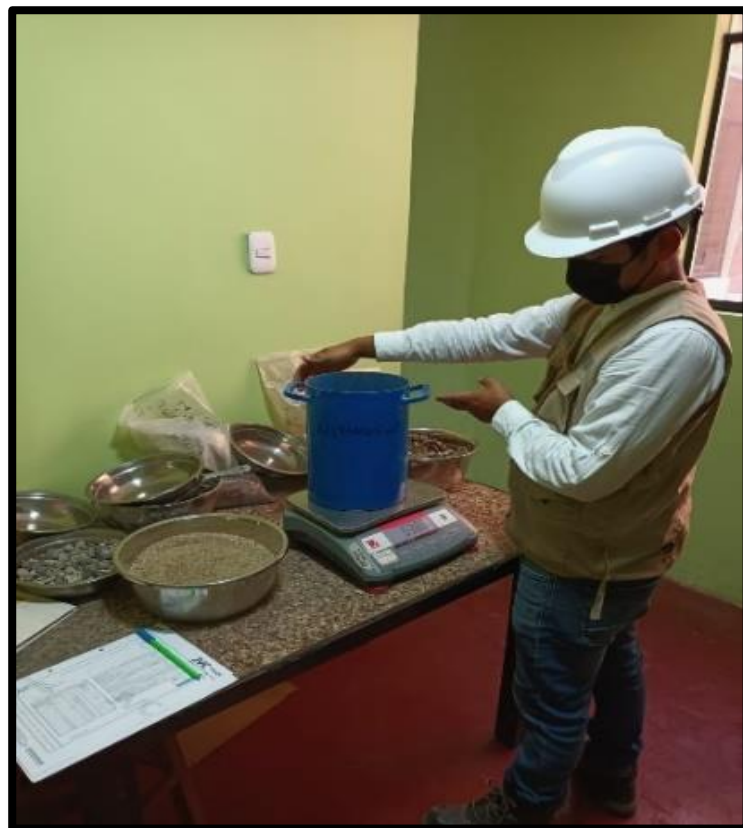
Figura 16: Peso de molde para Agregado Grueso
