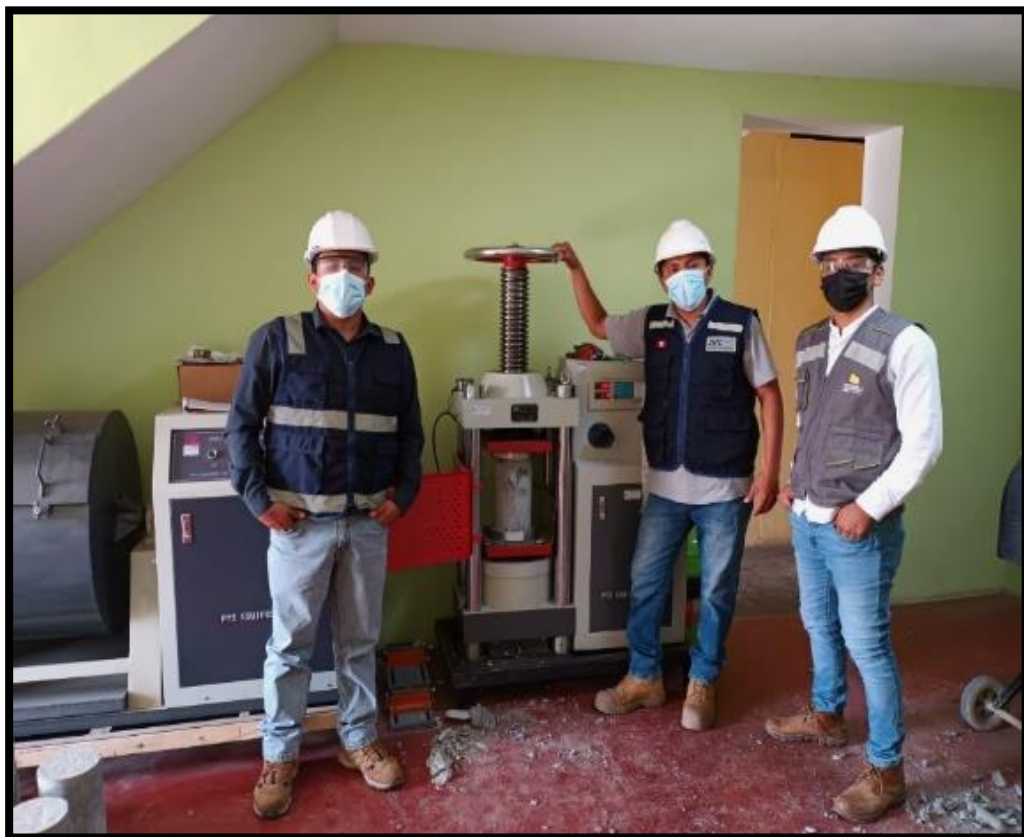
Figura 40: Maquina PyS equipos Cap. 100.000 Kgf – Lab. JVC
