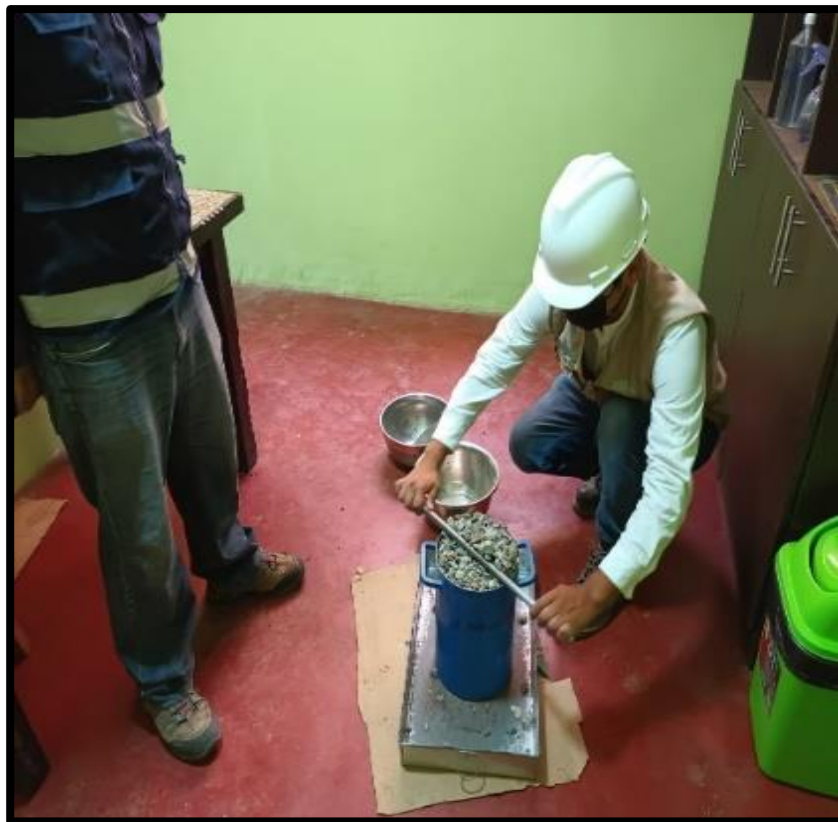
Figura 19: Enrasado de Agregados
