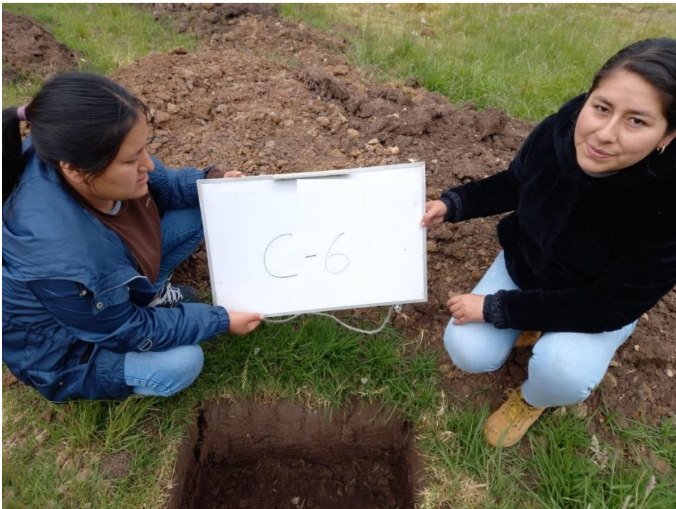
Imagen N°07: Estudio de Mecánica de Suelo – Calicata C-6 sustracción de muestra progresiva km. 15+250.0
