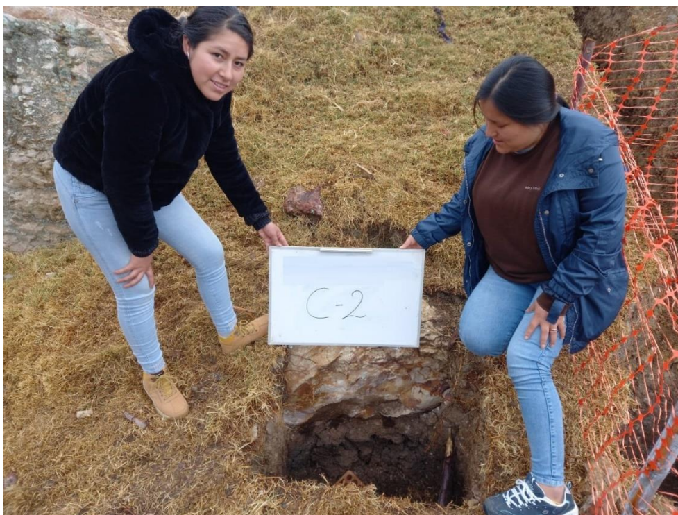
Imagen N°05: Estudio de Mecánica de Suelo – Calicata C-2 sustracción de muestra progresiva km. 3+000.0
