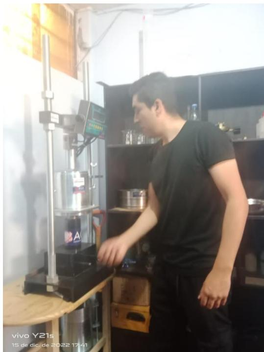
FOTOGRAFÍA 22. Ensayo de CBR
