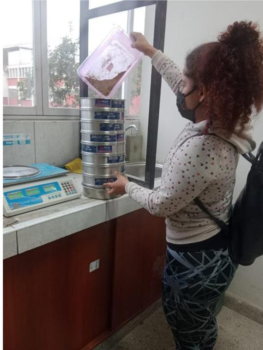
FOTOGRAFÍA 5. Ensayo de granulometría
