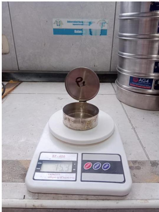
FOTOGRAFÍA 8. Pesado de recipiente – ensayo de contenido de humedad
