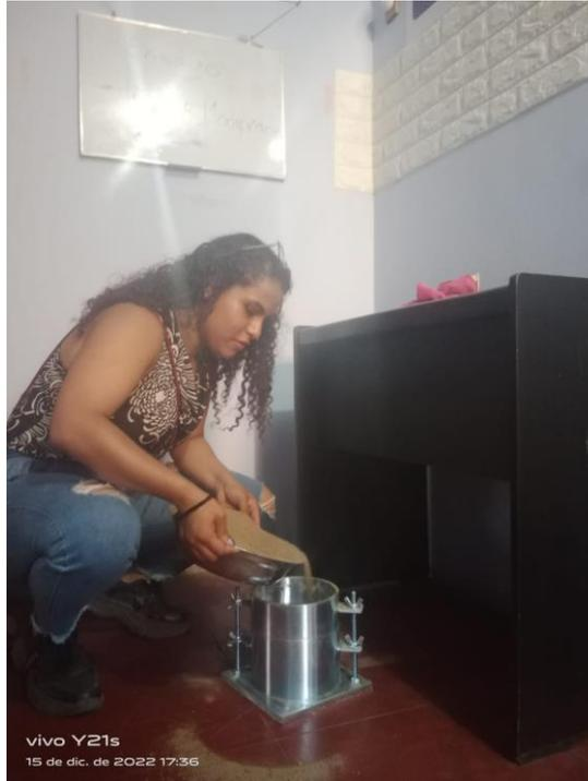
FOTOGRAFÍA 17. Llenado de capas del molde – ensayo de Proctor
