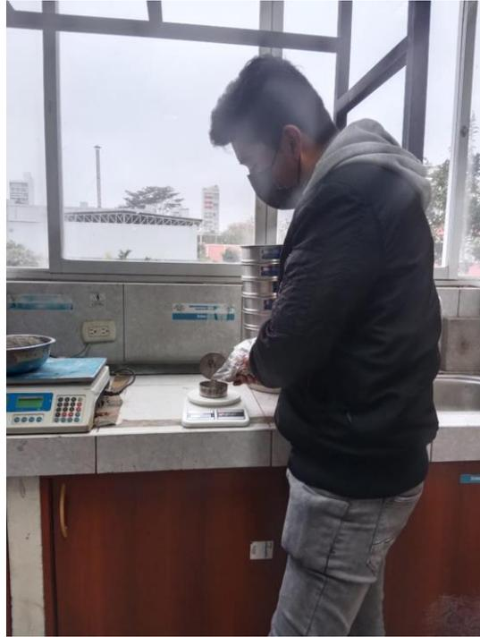
FOTOGRAFÍA 9. Agregando suelo – ensayo de contenido de humedad
