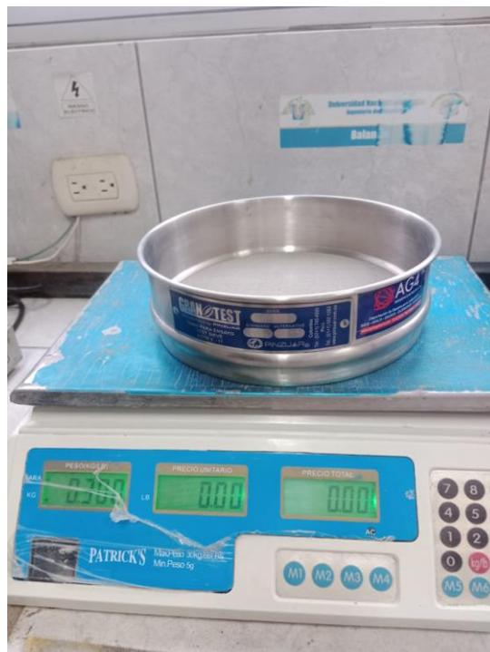
FOTOGRAFÍA 4. Pesado de malla – ensayo de granulometría
