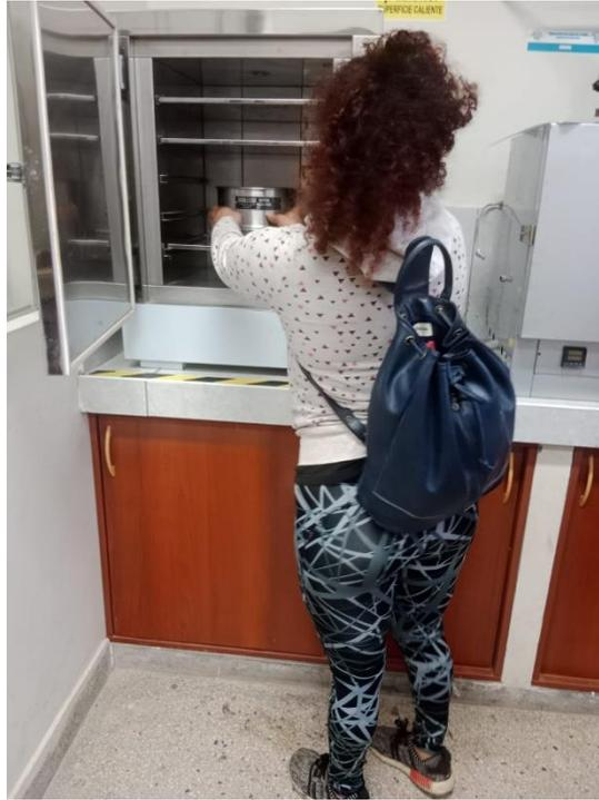
FOTOGRAFÍA 3. Secado de material en estufa – ensayo de granulometría por lavado
