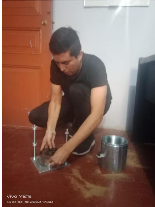
FOTOGRAFÍA 19. Colocado de masa sólida – ensayo de CBR
