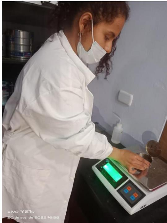
FOTOGRAFÍA 15. Pesado de recipiente – ensayo de límites de consistencia
