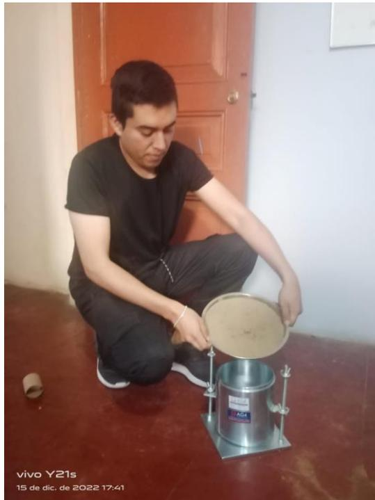
FOTOGRAFÍA 21. Agregando la muestra – ensayo de CBR
