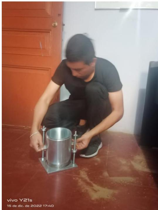
FOTOGRAFÍA 20. Colocado de molde – ensayo de CBR
