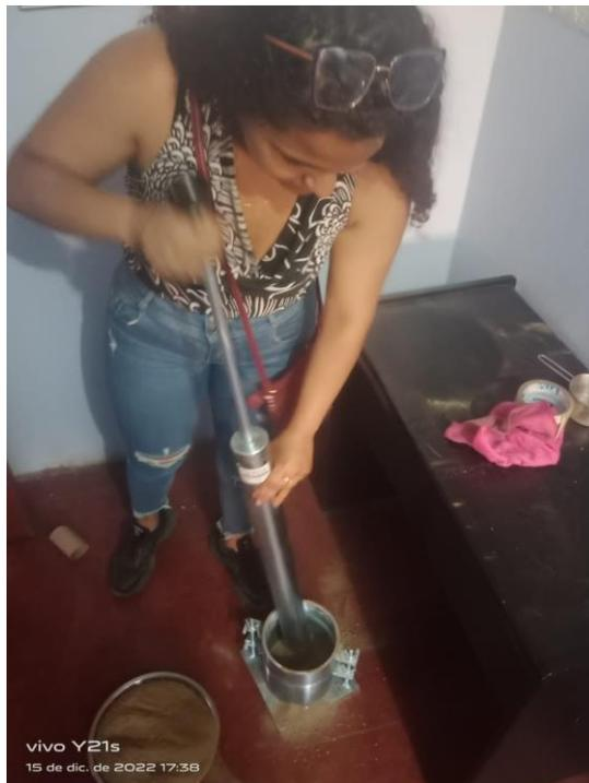
FOTOGRAFÍA 18. Compactación del suelo – ensayo de Proctor
