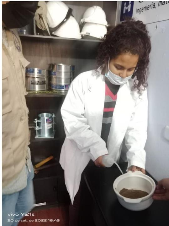
FOTOGRAFÍA 13. Dosificación del suelo – ensayo de límites de consistencia
