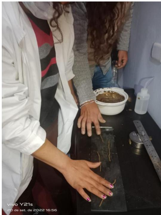
FOTOGRAFÍA 14. Límite plástico – ensayo de límites de consistencia
