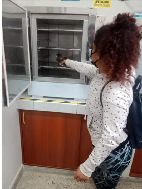
FOTOGRAFÍA 11. Colocando muestras en estufa para secado – ensayo de contenido de humedad
