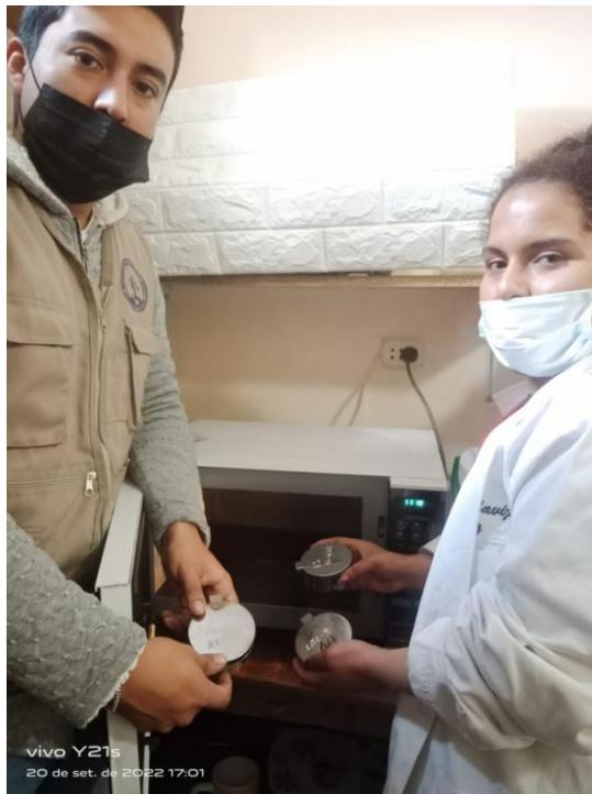
FOTOGRAFÍA 16. Colocando en estufa para secado – ensayo de límites de consistencia
