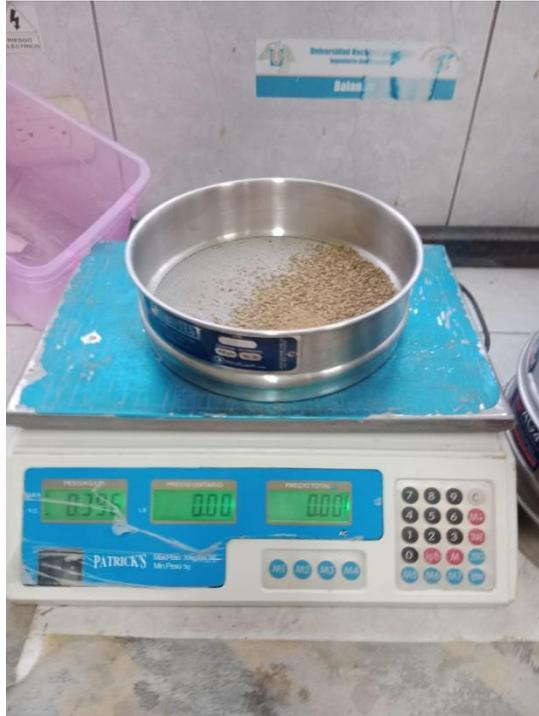
FOTOGRAFÍA 7. Material retenido de suelo – ensayo de granulometría
