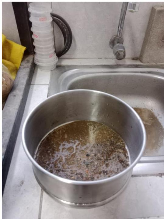
FOTOGRAFÍA 2. Material después del lavado – granulometría por lavado
