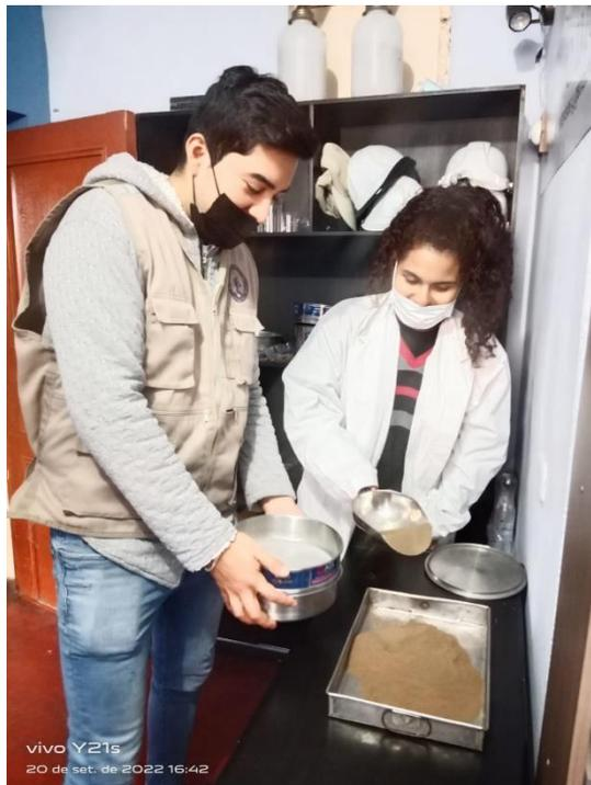
FOTOGRAFÍA 12. Tamizado de material por la malla 10 – ensayo de límites de consistencia
