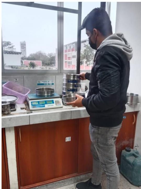
FOTOGRAFÍA 6. Pesado de malla con material retenido – ensayo de granulometría
