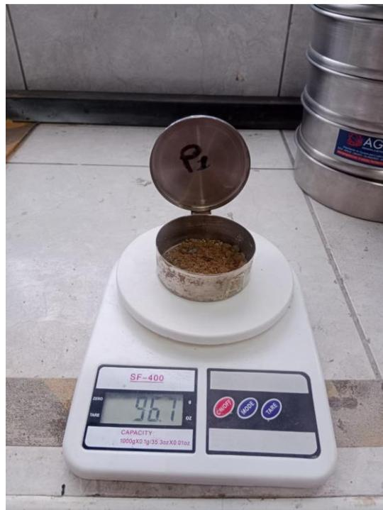
FOTOGRAFÍA 10. Pesado de material con el recipiente – ensayo de contenido de humedad
