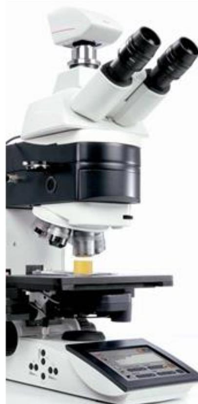
Leica DM6000 M con tubo de documentación MBOT motorizado.
