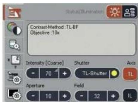
Mediante el nuevo panel externo SmartTouch Leica STP6000 se pueden manejar a distancia todas las funciones automáticas del microscopio. Para ello se trabaja con la misma interfaz de usuario intuitiva que tiene el software Leica Application Suite.
