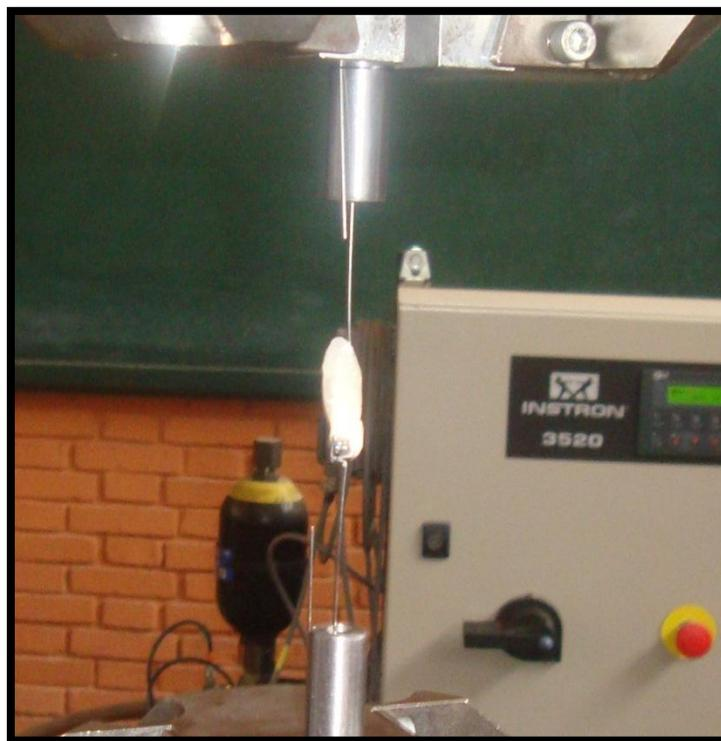
Ejecución de la parte final del ensayo, en donde se coloca cada muestra preparada en la máquina de Ensayos Universal Instron para evaluar la fuerza de adhesión de brackets en dientes con y sin blanqueamiento.
