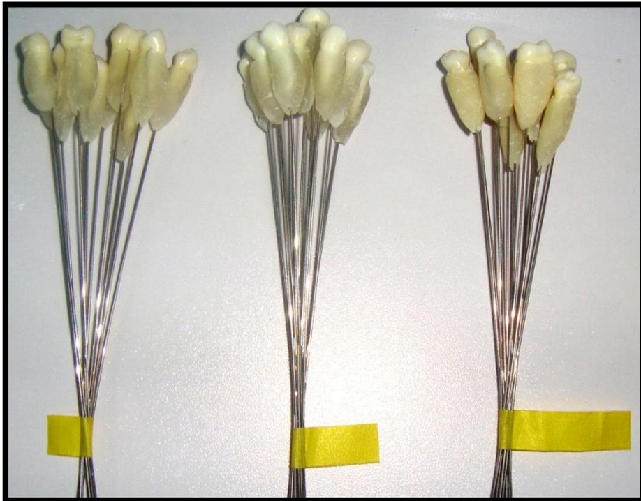
Mescla de acrílico transparente autopolimerizable, y aplicación del mismo en cada muestra para fijar diente – alambre y Muestras finales completamente terminadas (3 grupos)
