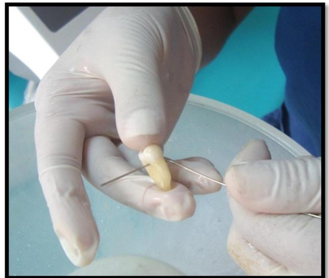
Materiales e instrumentos empleados para la fase de microtensión, se realiza un agujero con una fresa redonda diamantada y se introduce un alambre de ortodoncia para luego fijarlo.
