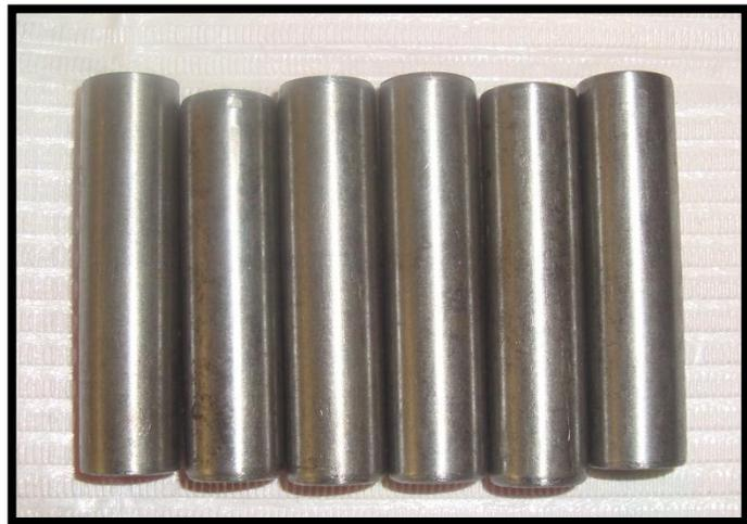
Se confecciona una estructura en forma de cuadrado con alambre de ortodoncia de 0.70 mm de tal modo que quede exacto alrededor del bracket para su posterior función y Se conformó unos soportes de acero “Brocas” de  $\frac{1}{2}$  pulgadas de ancho y 2 pulgadas de altura, para el montaje en la máquina de Ensayos Universal Instron.
