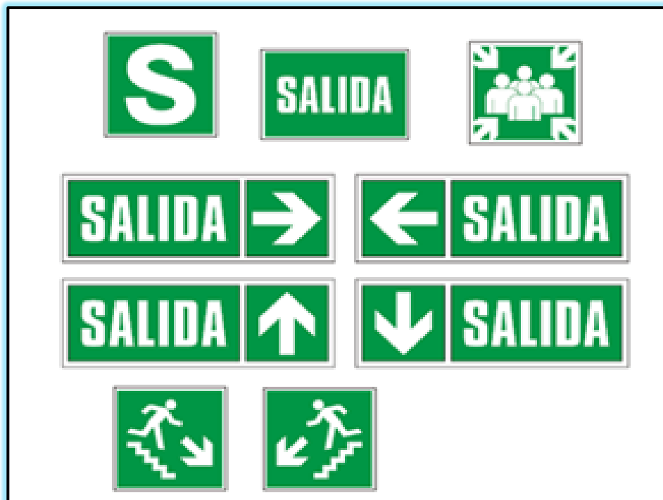
IMAGEN N° 145: Señales de Evacuación y Emergencia Fuente: NTO 399.010-1
