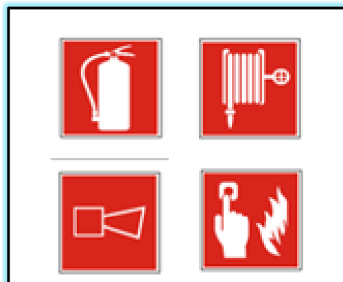
IMAGEN N° 146: Señales de Equipos Contra Incendios Fuente: NTO 399.010-1
