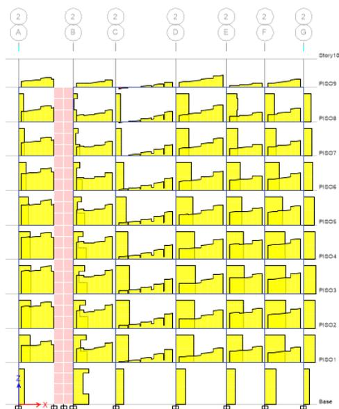
Nota: Esta ilustración muestra las envoltentes de fuerzas cortantes en el eje X en el pórtico 2-2 en el software ETABS, por Martínez y Verástegui, 2023.
