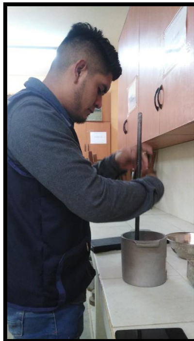
Figura 32. Apisonado para realización de Ensayo PUC.
