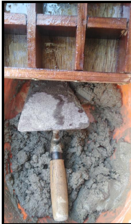
Figura 34. Preparación de mezcla para elaboración de moldes cúbicos de mortero.
