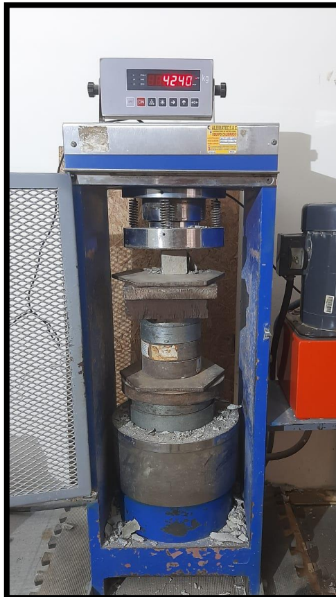
Figura 36. Ensayo de resistencia a la compresión con cubos de mortero.
