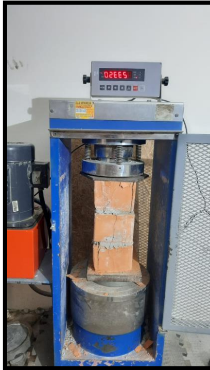
Figura 33. Realización de ensayo con prismas de albañilería.
