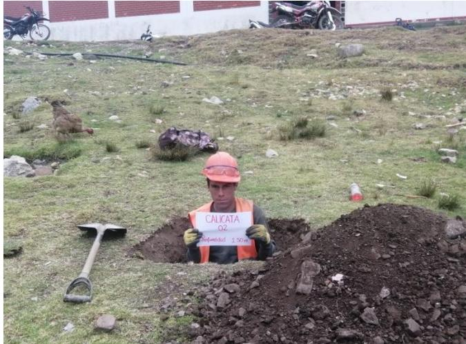
*Nota.* En la Fotografía se muestra la calicata C-02, para conocer mediante los ensayos en laboratorio, la resistencia del terreno. Fuente: Expediente Técnico.
