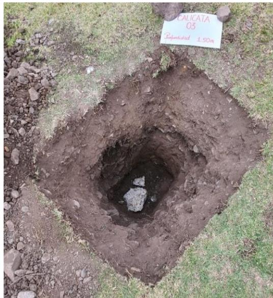
*Nota.* En la fotografía se muestra la calicata C-03, para conocer mediante los ensayos en laboratorio, la resistencia del terreno. Fuente: Expediente Técnico.
