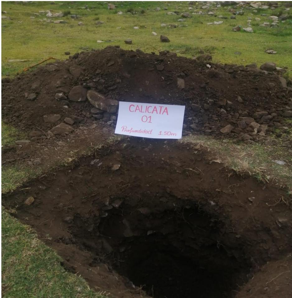
*Nota.* En la Fotografía se muestra la calicata C-01, para conocer mediante los ensayos en laboratorio, la resistencia del terreno. Fuente: Expediente Técnico.
