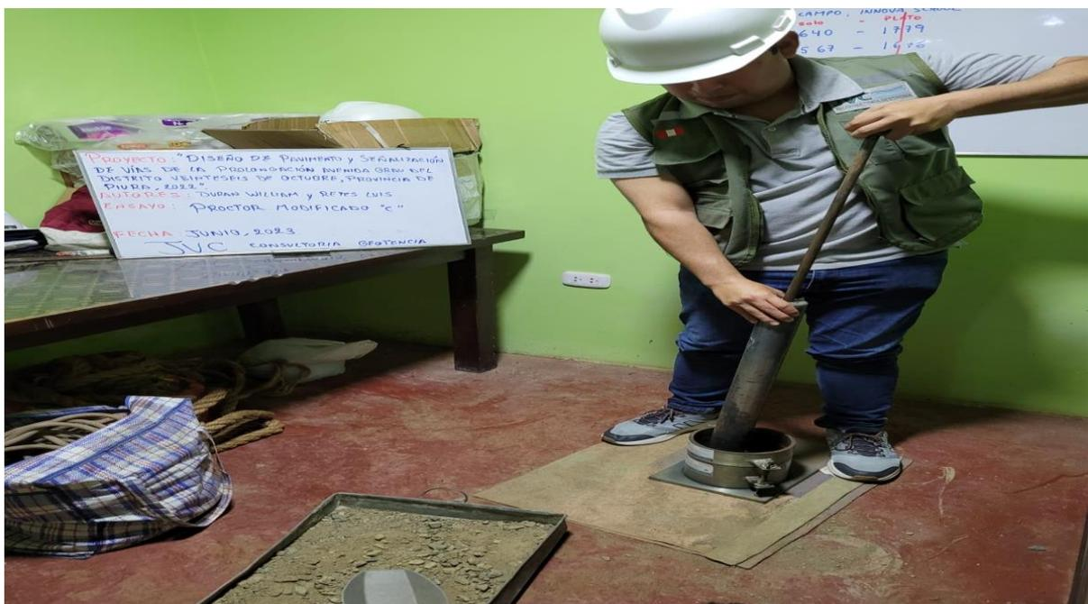
*Nota.* En la siguiente figura se observa el ensayo de Proctor Modificado.
