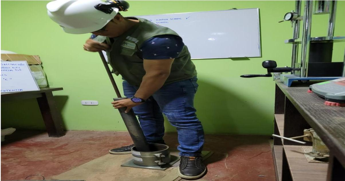
*Nota.* En la siguiente figura se observa el ensayo de Proctor Modificado.
