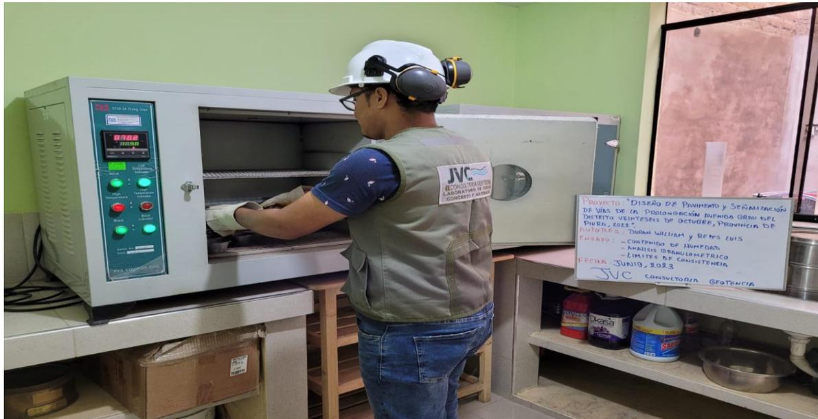
*Nota.* En la siguiente figura se observa la colocación de la muestra en el horno.
