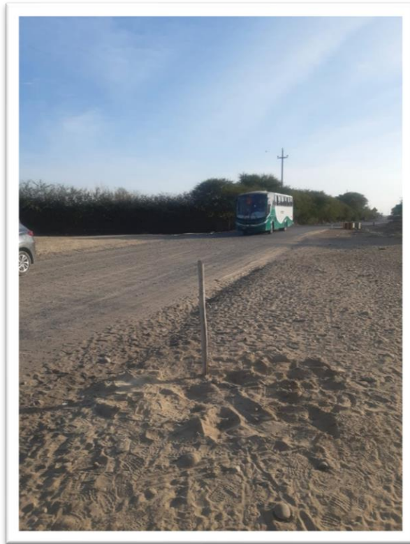
Foto 05: Se observa que el terreno natural está conformado por arenas limo arcillosas color marrón claro.
