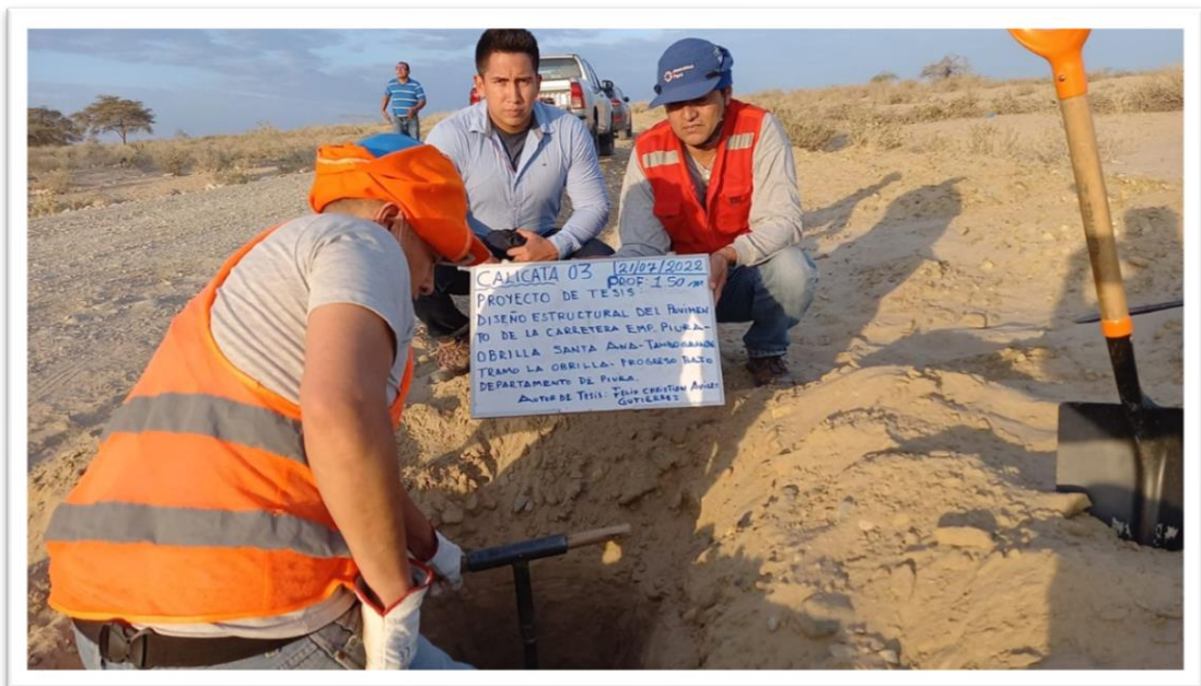
Foto 14: La exploración del sub suelo de la vía se realizó de acuerdo a la norma del MTC verificado por el Br Félix Christian Avilés Gutiérrez.
