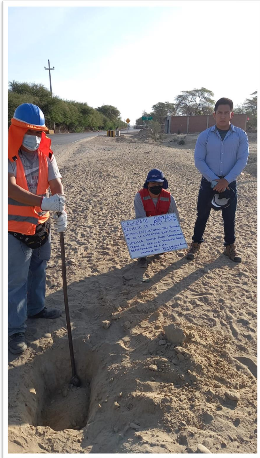
Foto 17: Calicata 1 lado izquierdo de la vía coordenadas N9449605 E549218 con profundidad de 1.50m verificada por el Br Félix Christian Avilés Gutiérrez
