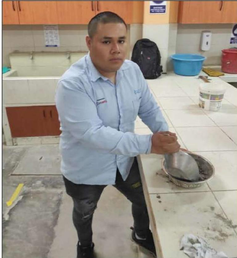
Al retirar <sup>1</sup> el agregado del horno se procede a pesarlo y colocarlo en la tabla de granulometría de agregados que se mostrará a continuación, luego colocamos el agregado a los tamices y procedemos a agitarlos.
