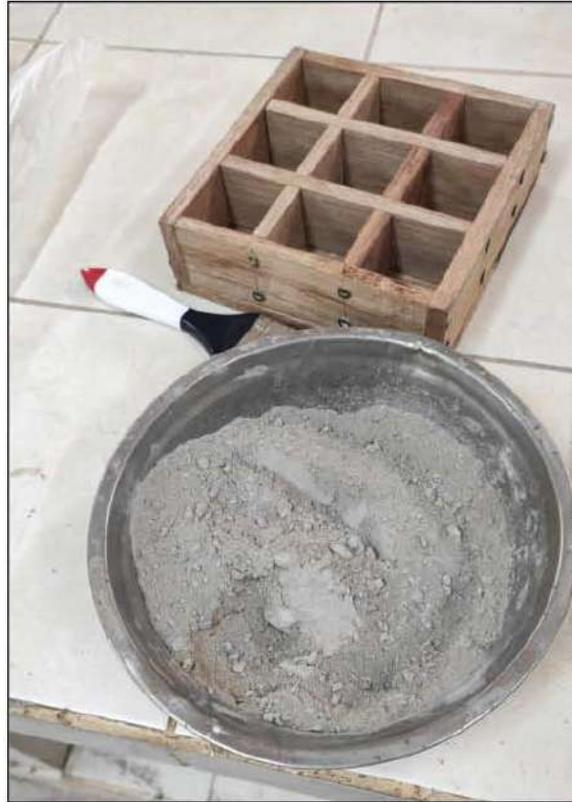
Luego apisonamos el mortero en cada muestra cúbica 32 veces en 4 rodadas aproximadamente 10 segundos cada una, cada vuelta fue de 8 golpes sobre la superficie de nuestra mezcla. Pasamos la parte plana de la espátula sobre la longitud del molde para poner en nivelación el mortero y colocamos los cubos de nuestra mezcla en un gabinete húmedo por 3 días exponiendo las superficies exteriores al aire húmedo.
