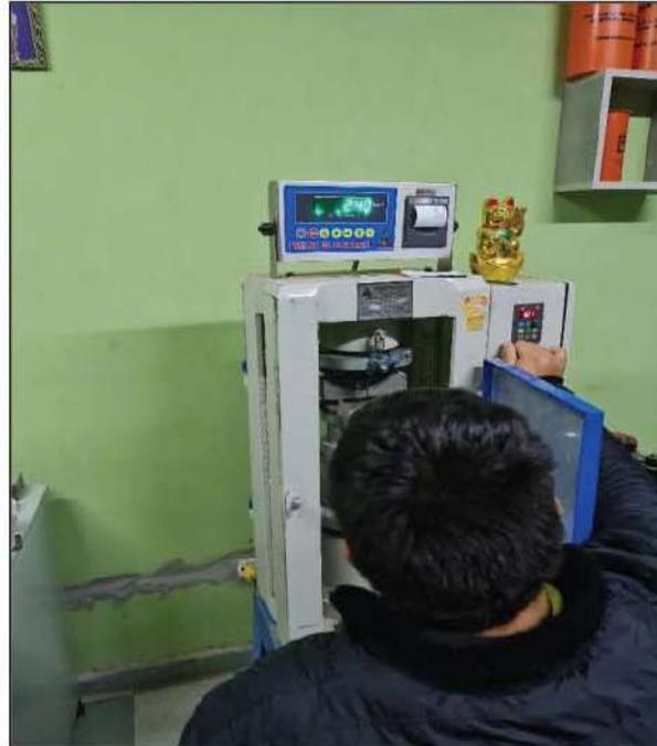
Aplicamos una carga en el punto medio de nuestra viga, manteniendo una velocidad constante de 0.10 kn/s cuando empieza la prueba hasta que se produjo la primera rotura de la probeta. Y calculamos el módulo de rotura con la fórmula siguiente:
