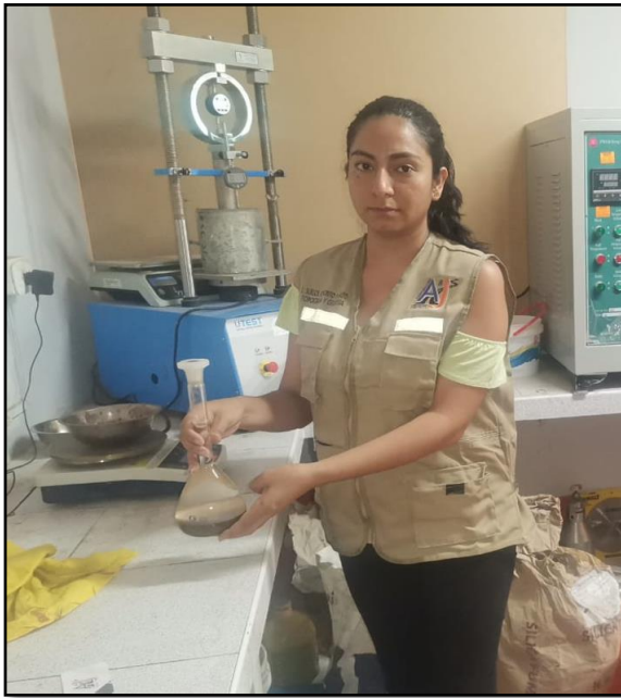
Preparación para la humectación de la muestra de suelo con su óptimo contenido de humedad para el desarrollo del ensayo de CBR.
