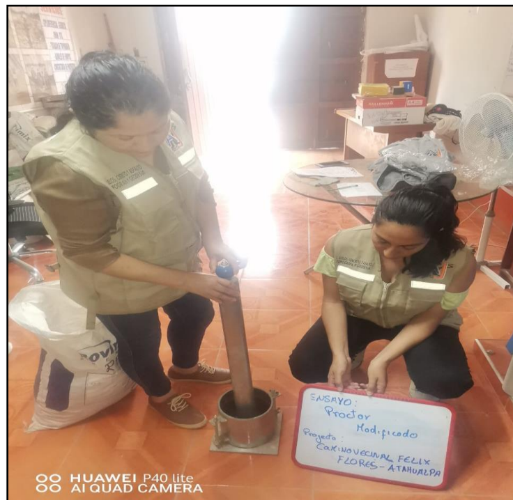
Humectación de la muestra de suelo utilizada para el Proctor modificado
