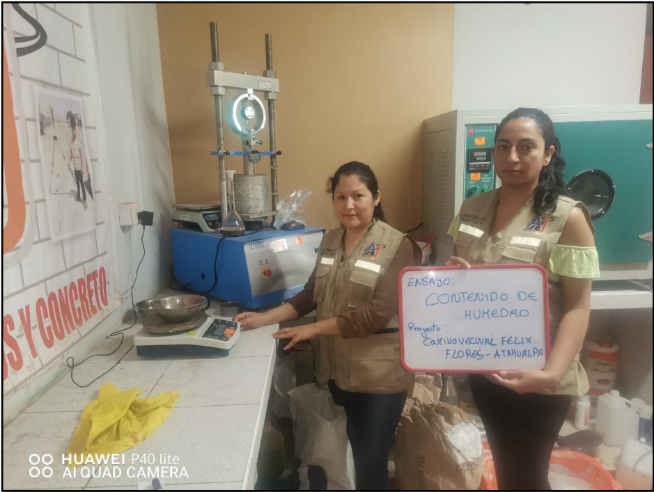
Pesado de muestra de suelo extraída.
