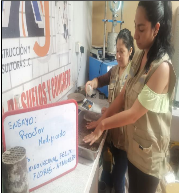
Humectación de la muestra de suelo utilizada para el Proctor modificado
