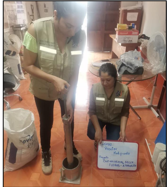
Desarrollo del ensayo de Proctor modificado
