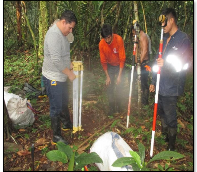
Nivelación y utilización de jalones
