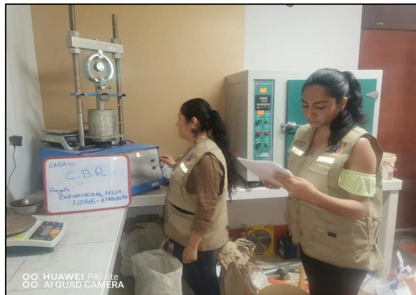
Desarrollo del Ensayo de CBR con una prensa manual
