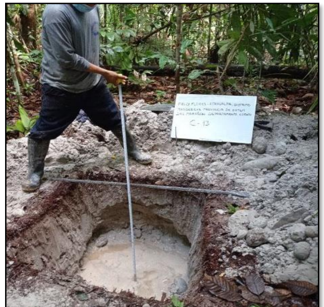
Profundidad de excavación de 1.50m
