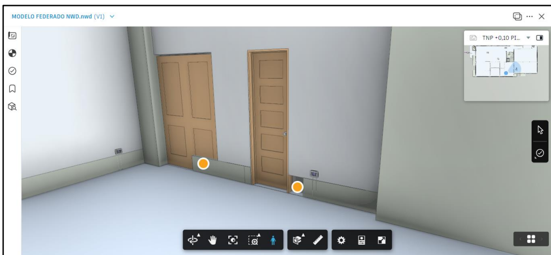
Figura 63. Interferencias entre sobrecimientos y puertas
