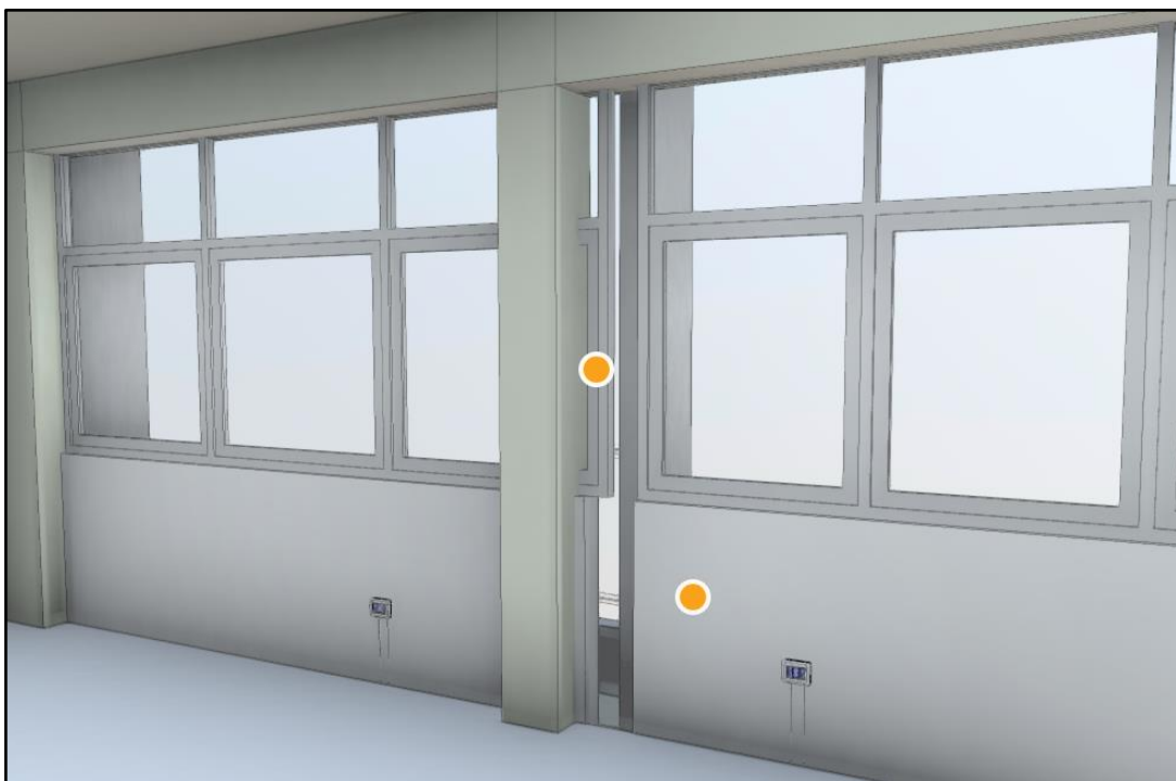
Figura 64. Interferencia entre columna y ventanas.
