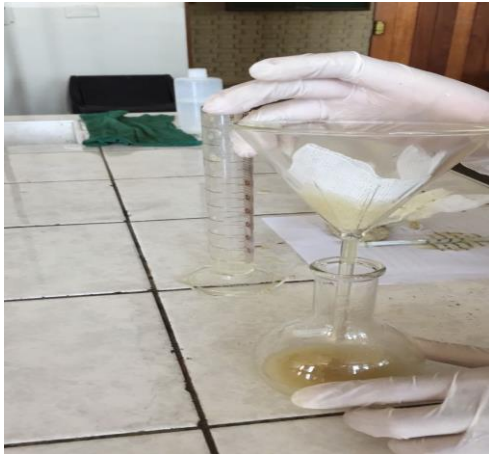
Filtración de almidón con gasa estéril.
