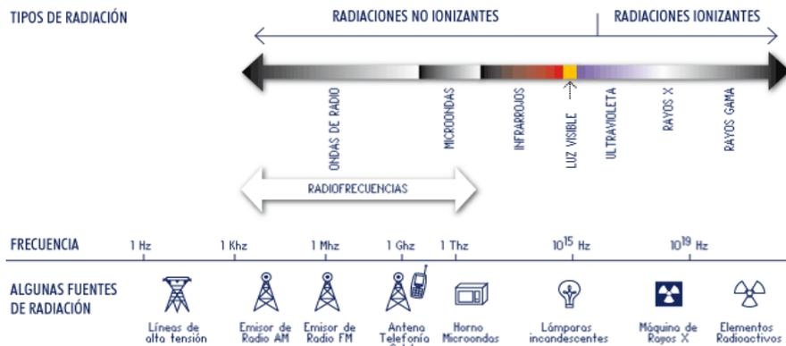
Figura N°1: Frecuencias que componen el espectro radioeléctrico
