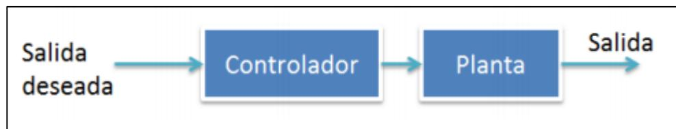
Fig 9: Lazo de control abierto
