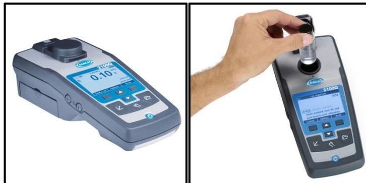
Figura N° 39: Sensor de turbidez HACH 2100Q
