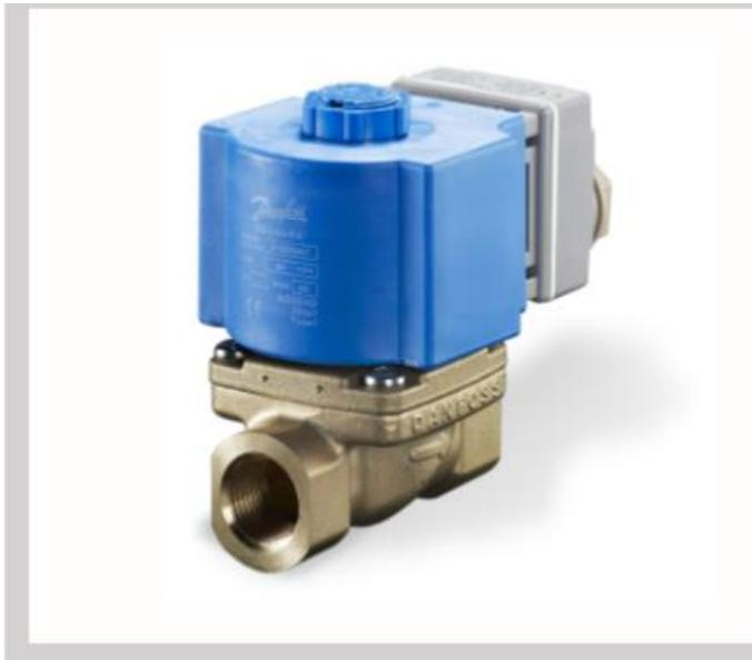
La gama EV260B se compone de válvulas solenoides servoaccionadas de 2 vías con función de modulación proporcional y conexiones de tamaños comprendidos entre 1/4" y 3/4". Mediante la regulación continua de la corriente de la bobina, es posible situar la armadura en cualquier posición del tubo de la armadura y, de este modo, ajustar la bobina entre las posiciones de cierre completo y apertura completa. La válvula se abre totalmente cuando la corriente de la bobina alcanza su máximo valor.
