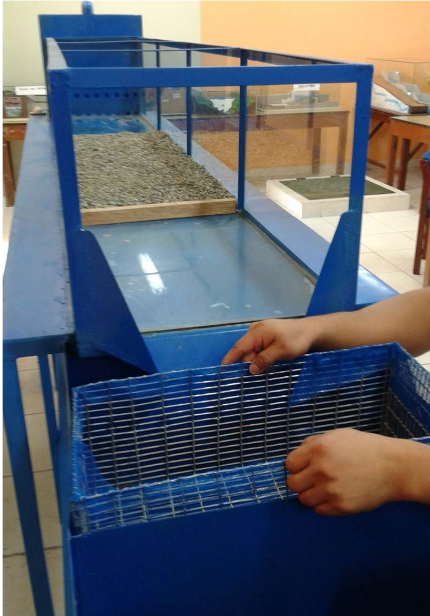
Colocación de la rejilla en el vertedero para no permitir el paso del material. Fuente: Elaboración propia.
