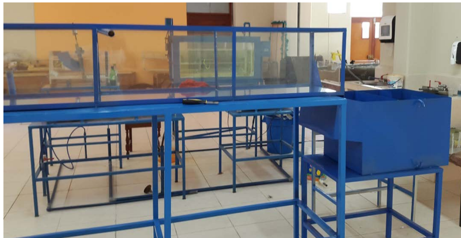
Colocación de las lunas en el canal hidráulico. Fuente: Elaboración propia.
