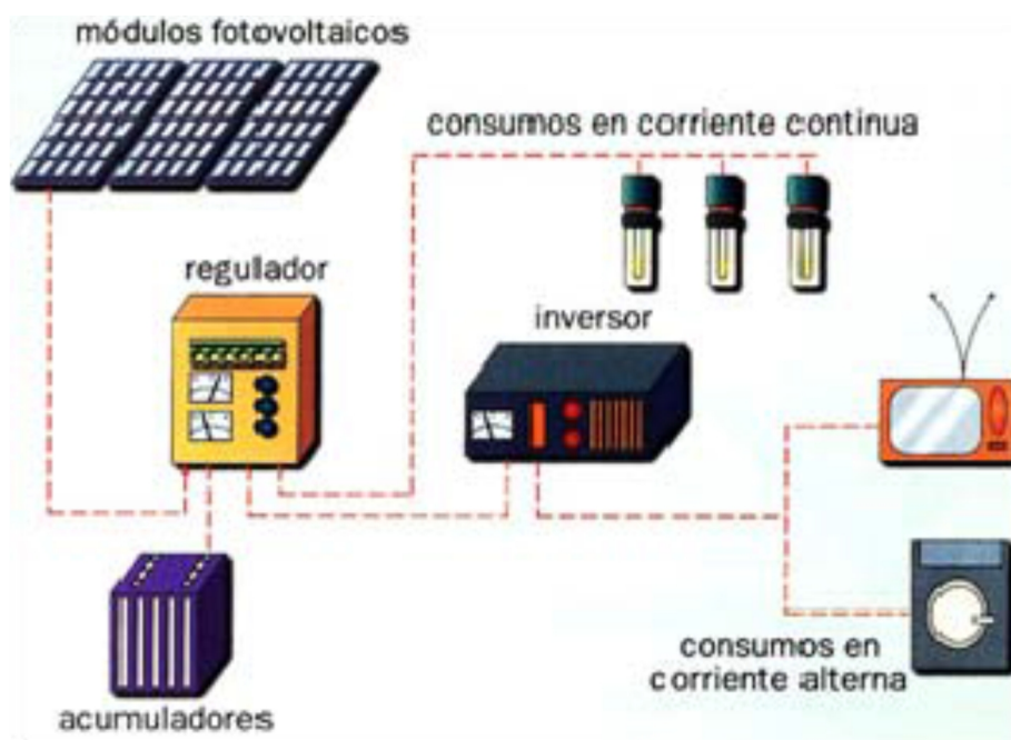
Figura N° 23 : Esquema típico SFV de uso doméstico
