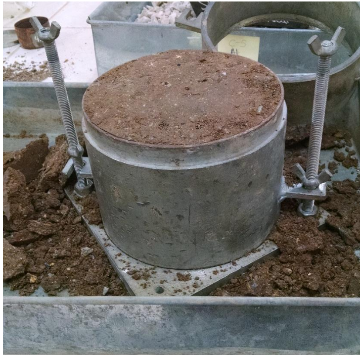
MOLDE CON MUESTRA COMPACTADA – ENSAYO DE PROCTOR MODIFICADO
