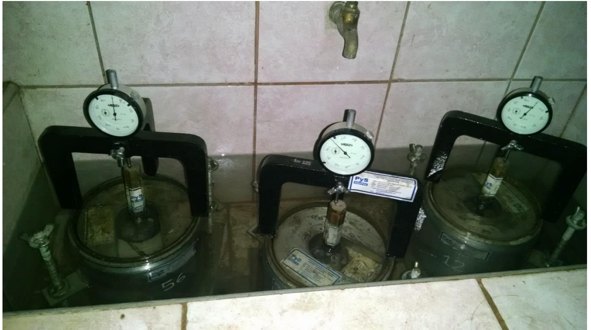
ENSAYO DE CBR EN LABORATORO – EXPANSION 1
