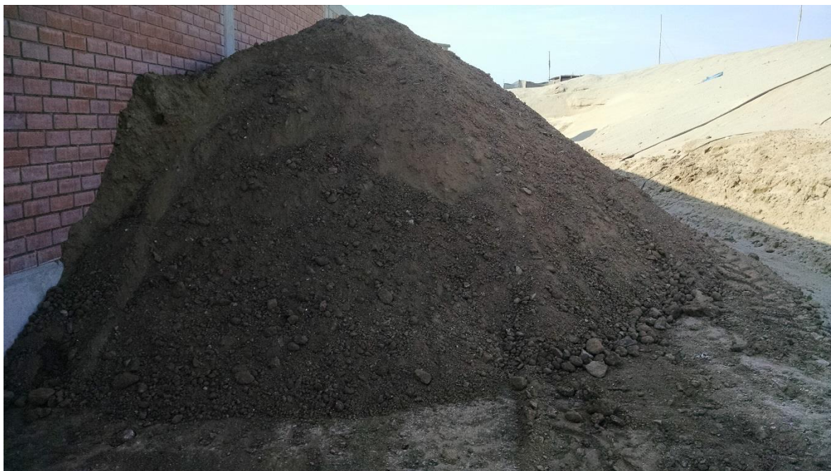
AFIRMADO ARCILLOSO PARA PISTA DE PRUEBA
