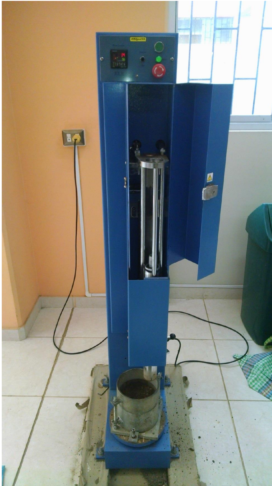
COMPACTACIÓN DE MATERIAL AFIRMADO - ENSAYO DE PROCTOR MODIFICAD
