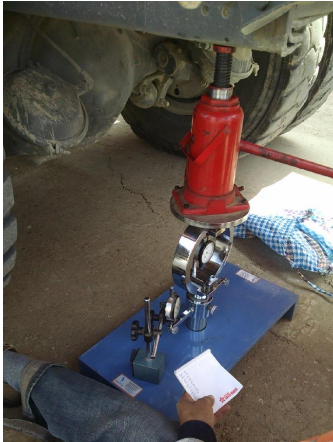
Fig. 3.2.7.1 Prensa de Carga para ensayo de CBR IN SITU
