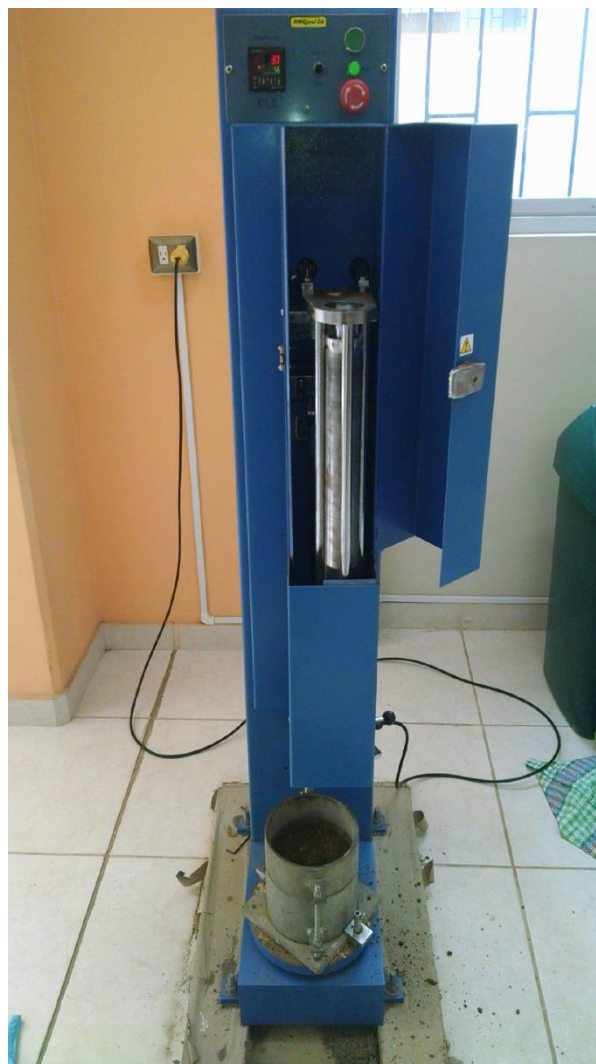
Figura 3.2.5 - Compactador automático de suelos para ensayo de Proctor y CBR.
