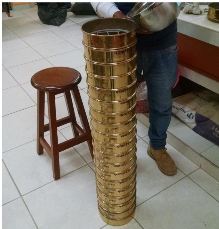
Figura 3.2.3.3 – 18 Tamices: Mallas: 2 ½”, 2”, 1½”, 1”, ¾”, ½”, 3/8”, N°4, N°8, N°10, N°16, N°20, N°30, N°40, N°50, N°80, N°100, N°200
