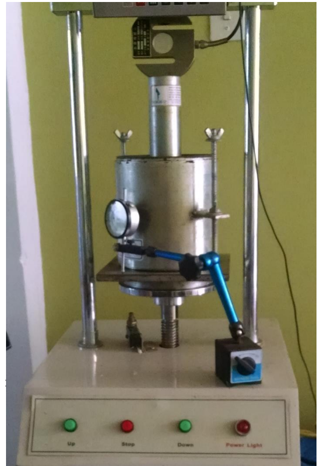
Figura 3.2.6.1 - Compactador automático de suelos para ensayo de Proctor y CBR.
