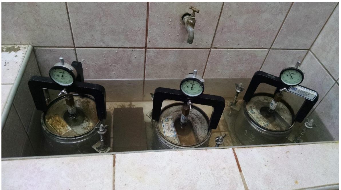
ENSAYO DE CBR EN LABORATORO – EXPANSION 2
