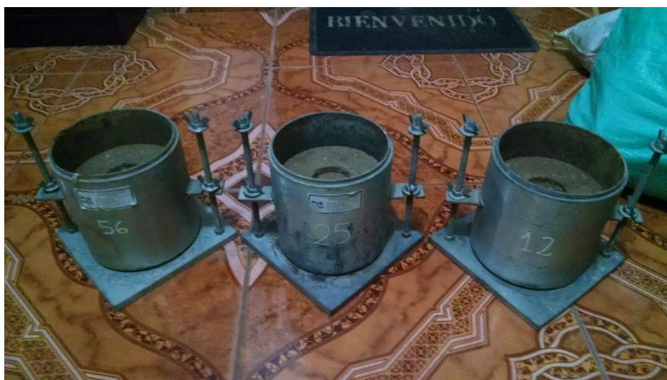
Figura 3.2.6.2 – Moldes Marshall para ensayo de CBR en laboratorio
