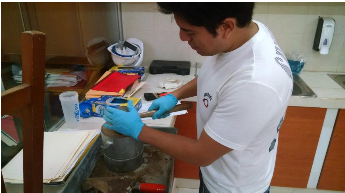
DESMOLDANDO EL MATERIAL COMPACTADO - ENSAYO DE PROCTOR MODIFICADO
