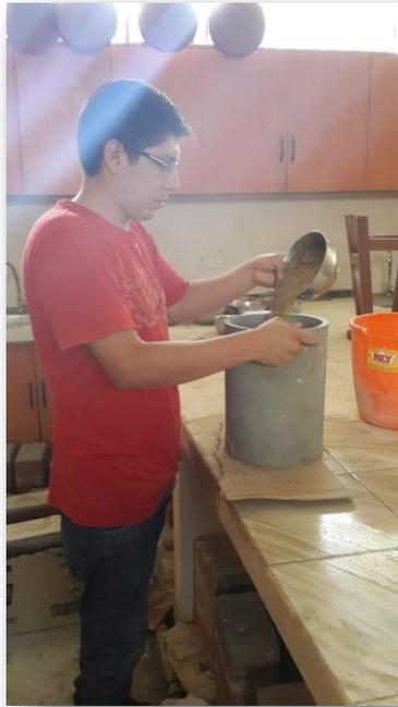
**Figura 5.** Recipiente para el ensayo de peso unitario.
