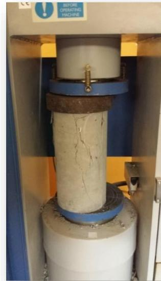
**Figura 14.** Prueba finalizada de resistencia a la compresión.
