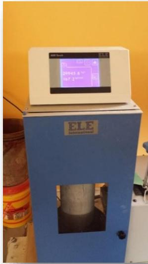
**Figura 13.** Prueba de resistencia a la compresión.
