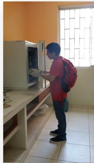
**Figura 4.** Muestra en horno a una temperatura de 110°C por 24 horas.
