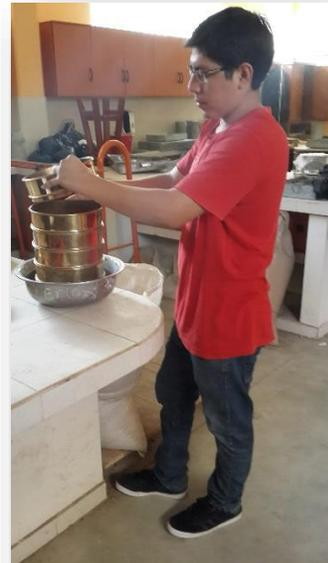
**Figura 2.** Cantidad de agregado retenido en cada tamiz.
