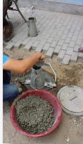
**Figura 10.** Prueba de slump en el cono de Abrams
