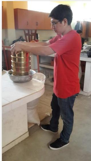
**Figura 1.** Agitado de columna tamices.
