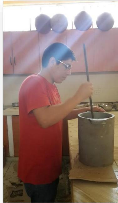
**Figura 6.** Compactando la primera capa de la muestra del agregado
