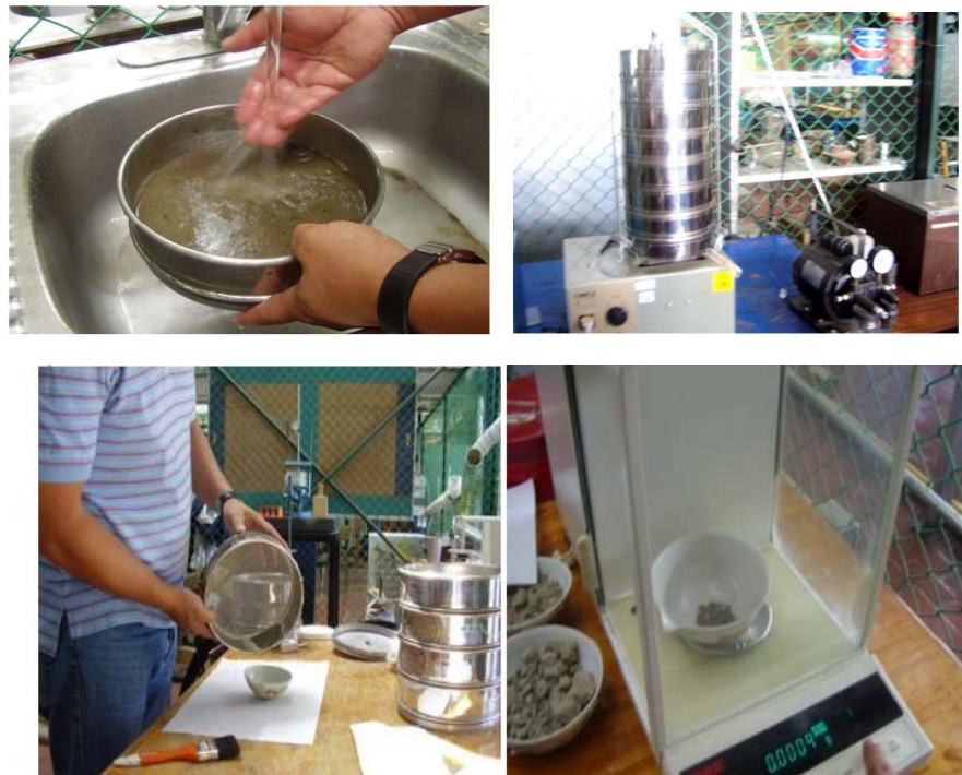
Fig. 3.6: Proceso para determinar la granulometría de las muestras del terreno
