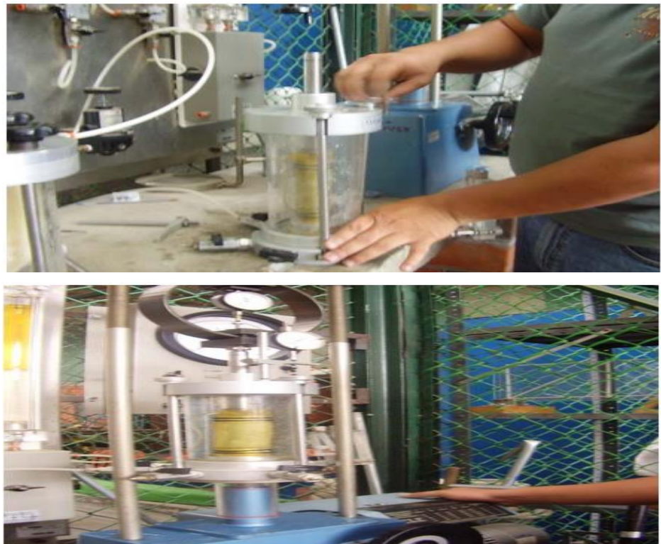
Fig. 3.11: Prueba triaxial rápida R, no consolidada no drenada.
