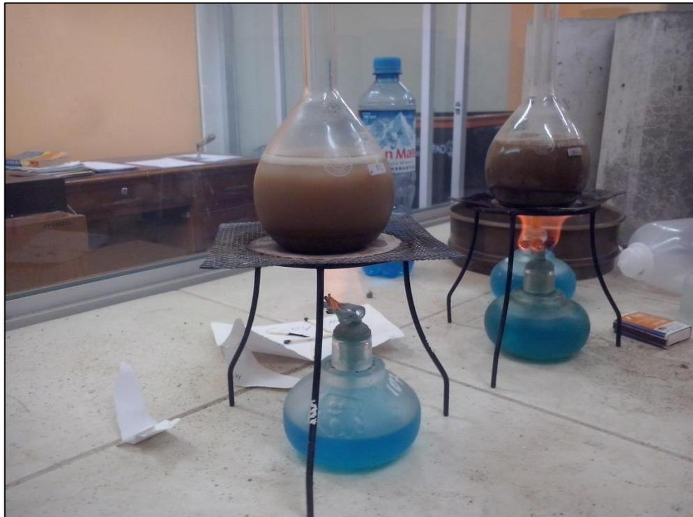
*Proceso de extracción de aire atrapado dentro de la suspensión suelo-agua de la muestra.*
