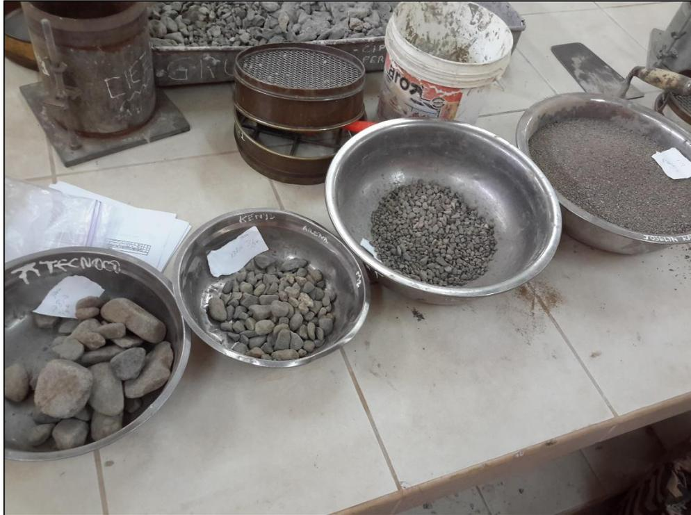
*Obtención de la muestra para el ensayo de proctor modificado, luego de realizar el tamizado por las mallas  $\frac{3}{4}$ ",  $\frac{3}{8}$ ", N° 4 y N° 200.*
