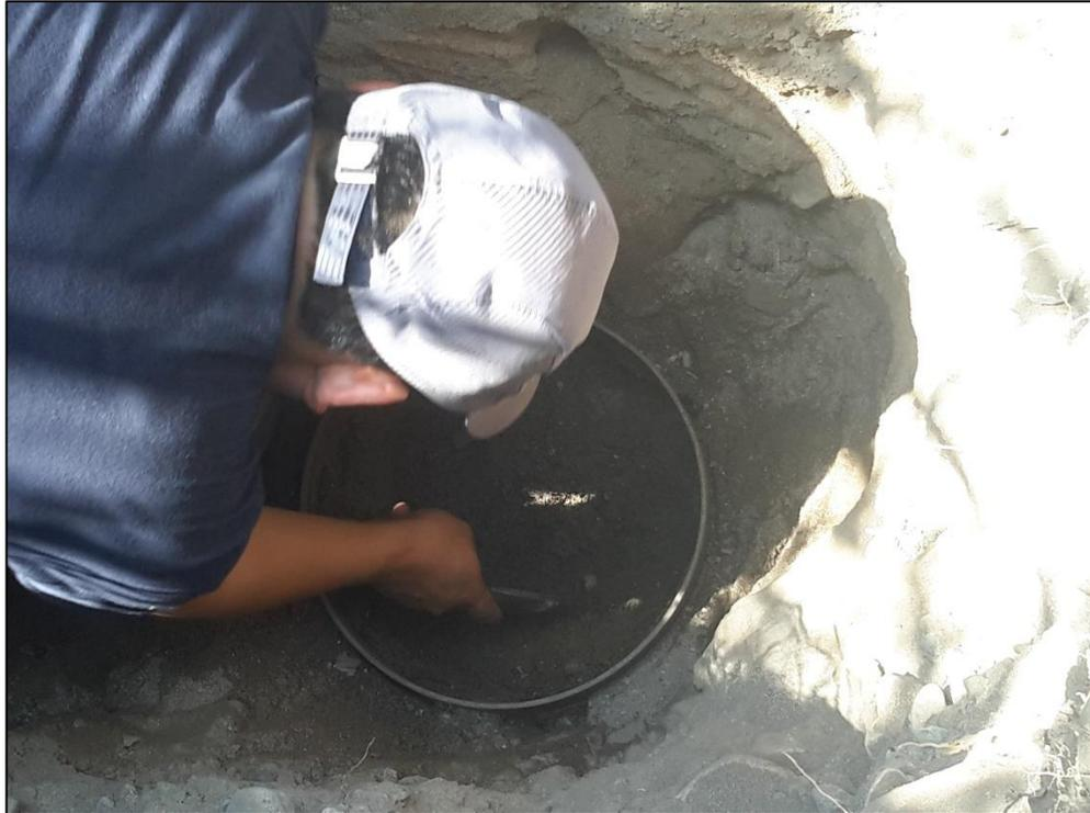
*Colocación del anillo metálico y obtención de la muestra para el cálculo de la densidad de campo.*
