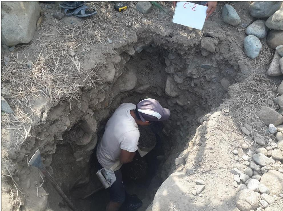
*Vista de la calicata N°2, mostrando la presencia de Nivel freático una profundidad de 2.00m*
