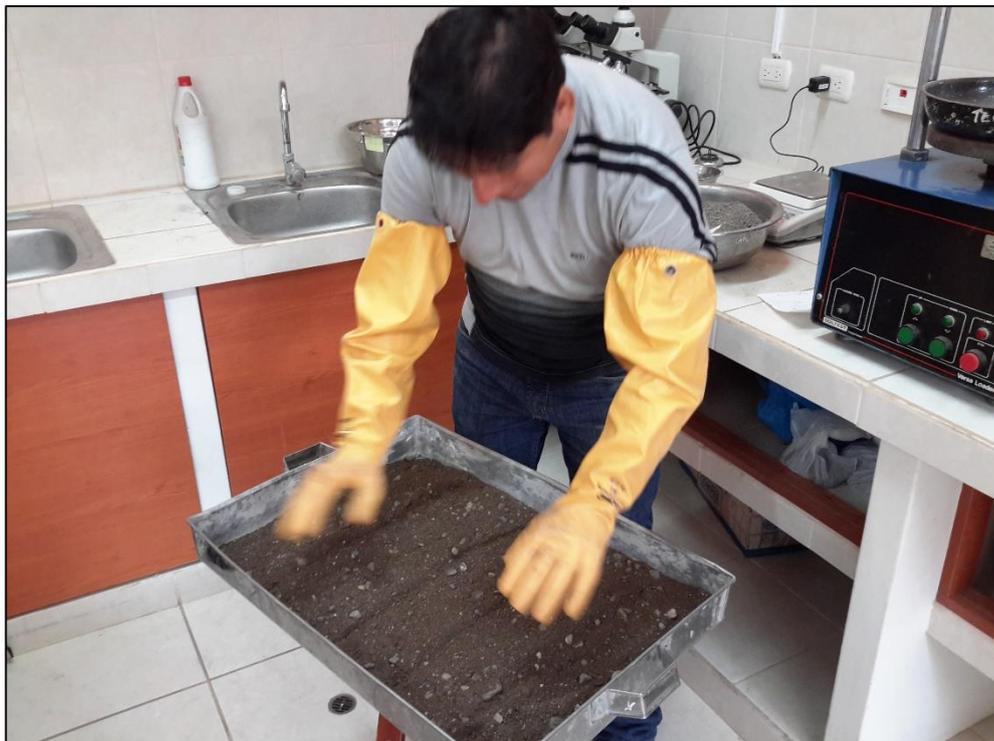
*Mezclado y separación de la muestra en 05 capas, al contenido de humedad del 2%, antes de llevarlo al molde de compactación.*
