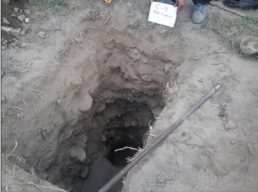
*Vista de la calicata N°4, mostrando material orgánico de 0 a 0.50m (primer estrato) y de 0.50 a 2.00m un tipo de suelo SP (arena mal graduada)*
