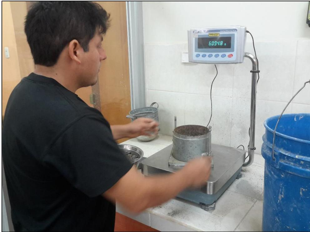
*Obtención del peso del molde para el ensayo de densidad suelta.*
