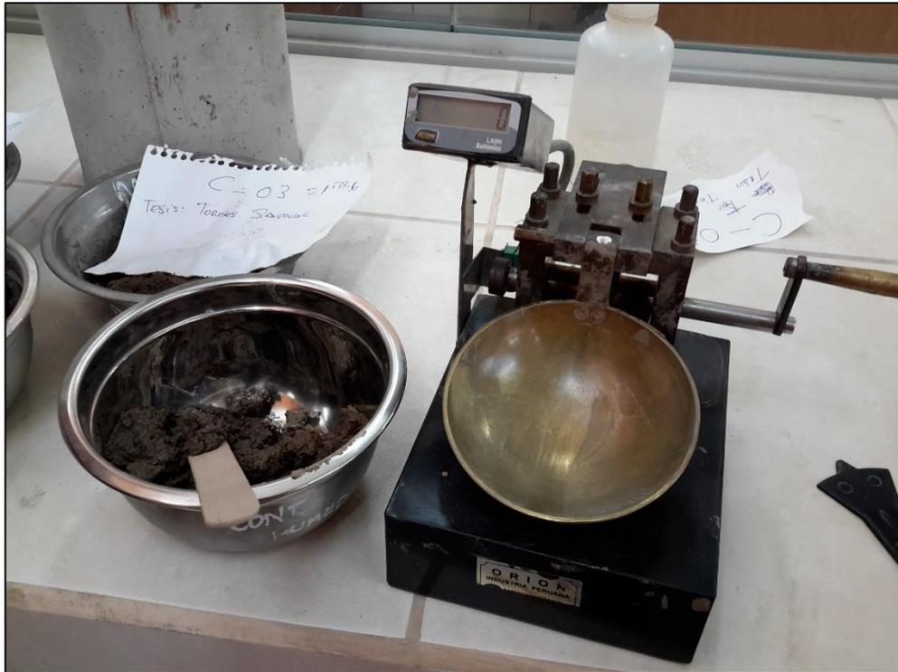
Se muestra el Ensayo de LL para la calicata 03
