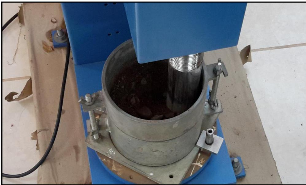
*Se visualiza como el martillo de base circular va compactando, uniformemente a las muestras de suelo, mediante 56 golpes a cada una de las capas de suelo ingresadas.*
