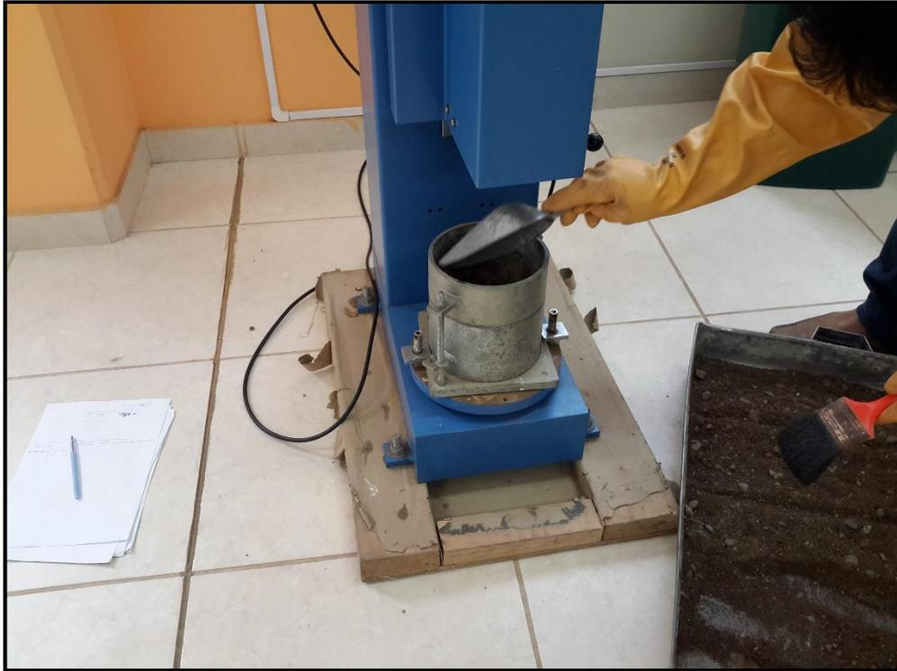
*Vaciado de la mezcla del suelo al molde de compactación. Cabe indicar que se ingresa al molde una capa de muestra a la vez.*
