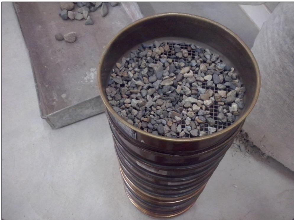
*Se muestra la separación y pesaje del suelo separado en sus diferentes tamaños*
