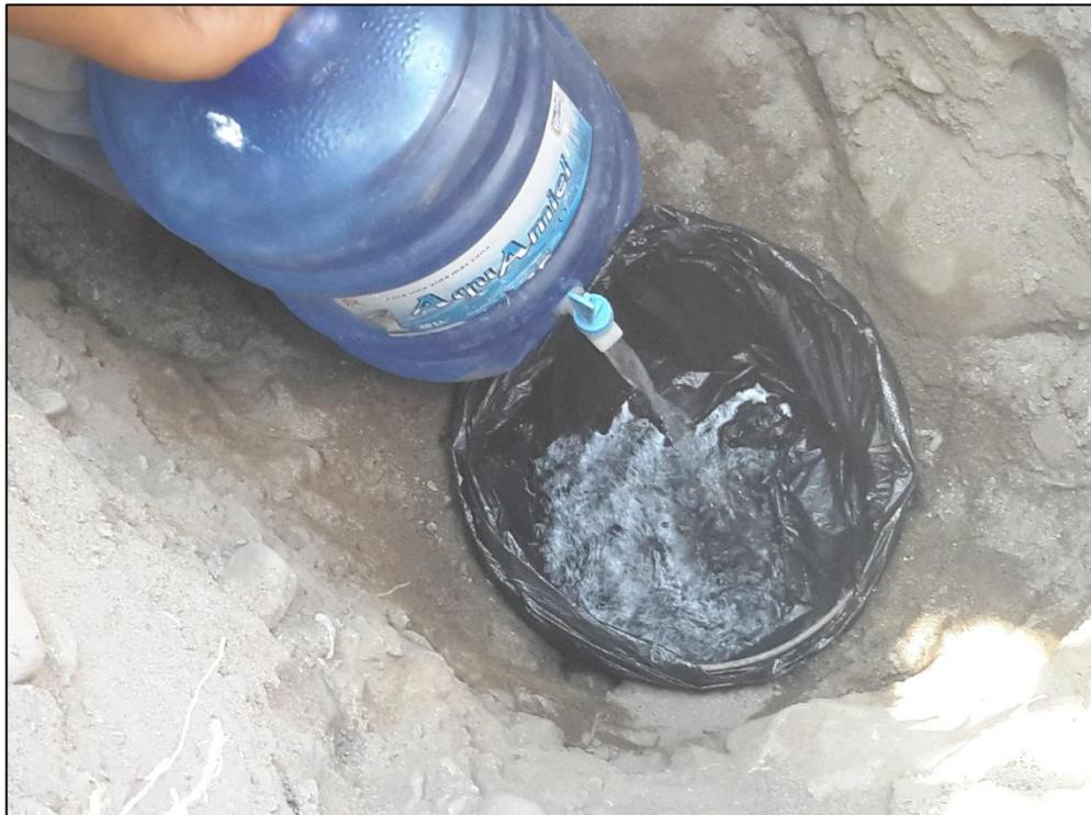
*Llenado con agua del hoyo de 15 cm de profundidad, para obtener el volumen de suelo extraído.*
