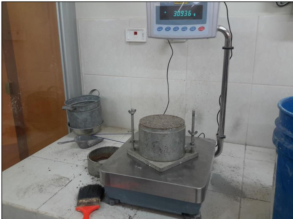
*Pesado del molde + suelo seco, para la obtención de la densidad suelta.*
