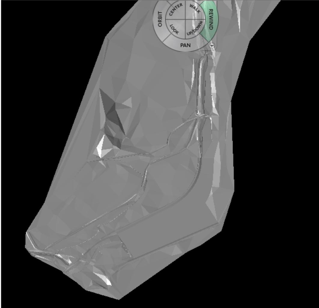
**Figura 17. Modelo tridimensional de terreno final, mostrando el dique proyectado colocado en el terreno natural Aguas arriba (Antes de Baden)**
