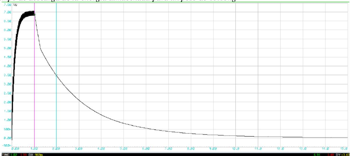
En la figura 20 se observa cómo cambia el voltaje generado por la baldosa para diferentes conexiones eléctricas con un peso de 70.7kg. Donde se evidencia que la mayor cantidad de tensión eléctrica se obtiene para una disposición cuadrangular y conexión paralelo.
