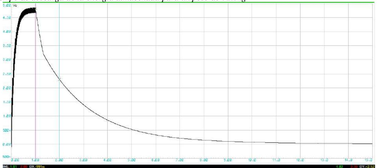
El tiempo de descarga de la energía almacenada para un peso de 85.85kg se da desde 1s hasta 11s, por tanto, el intervalo de tiempo es de 10s, y la amplitud de inicio de la descarga exponencial es de 6.92v. Como se observa en la figura 17
