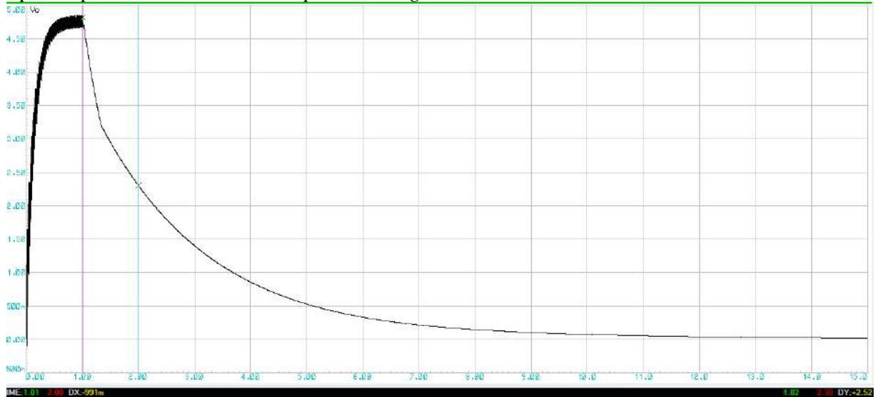
En la siguiente figura 16, se observa que en el tiempo comprendido desde 0 hasta 1 segundo, la baldosa genera energía y el circuito multiplicador la almacena en los condensadores C1, C3 y C5. En el tiempo comprendido desde 1 hasta 15 segundos, se produce la descarga de la energía generada por la baldosa en una carga de 100k. Además, tener en cuenta que la amplitud generada por la baldosa es de 1.38v para un peso de 85.85kg.
