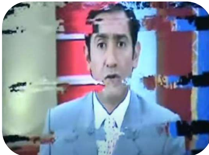
Figura 5. Efecto multitrayecto en televisión digital
