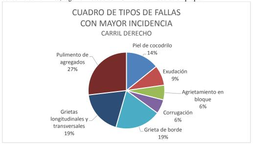
**Cuadro 09:** Cuadro resumen, nos indica que el tipo de falla presentada en el carril derecho es el pulimento de agregados (26%), grietas de bordes (19%), grietas longitudinales con un (18%), la piel de cocodrilo (14%), según el método del PCI. Fuente: Elaboración propia.
