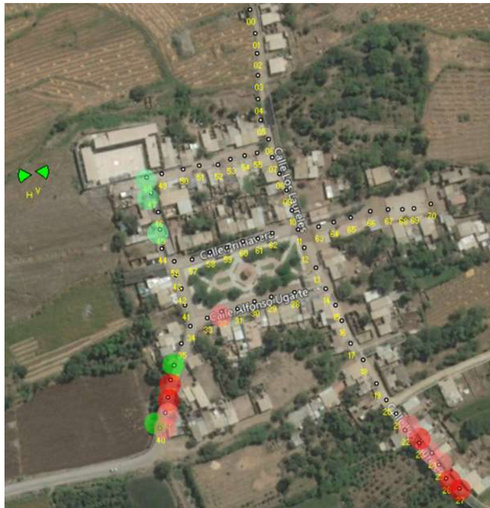
Figura 22: Emplazamientos con desvanecimientos y márgenes de mejora notables, señal en diversidad de polarización
