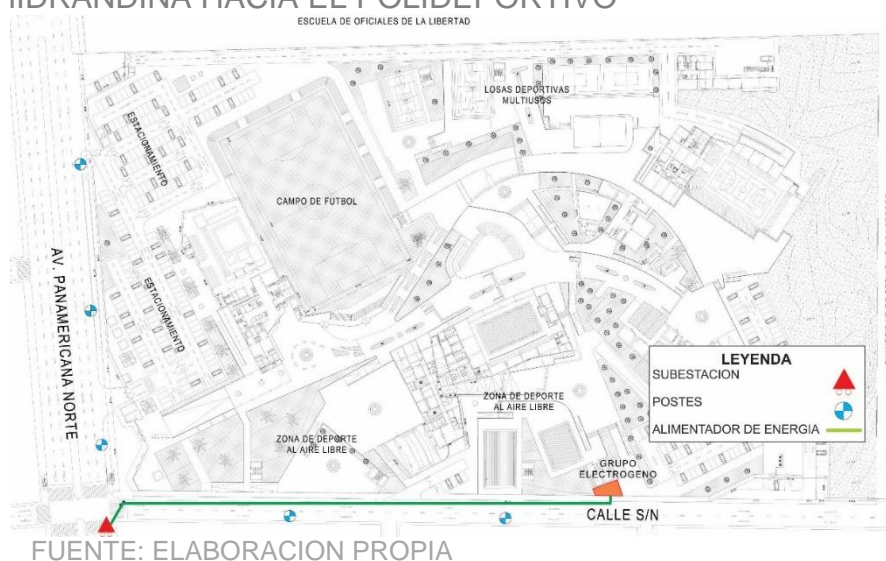
ILUSTRACION 70 ALIMENTACION DE ENERGIA ELECTRICA DE RED DE HIDRANDINA HACIA EL POLIDEPORTIVO
