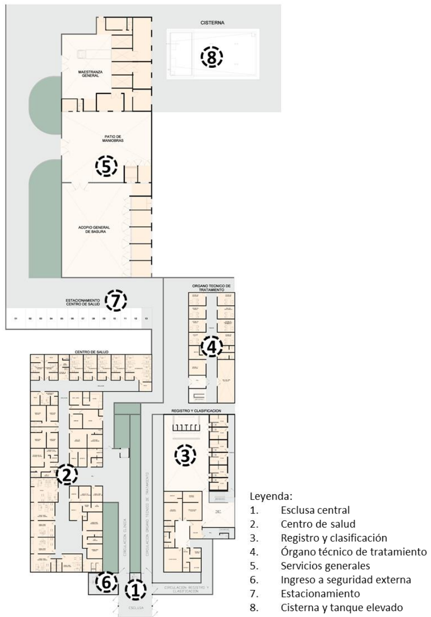
Ilustración 2.30 Planta 1 de la zona intermedia del proyecto
