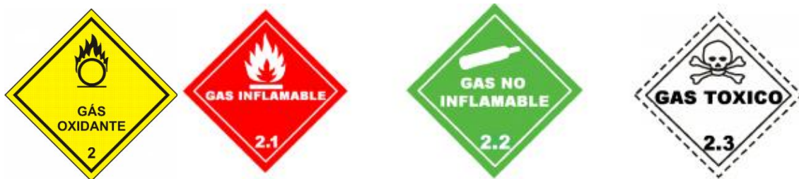
Figura 36. Simbología para gases comprimidos. (Fuente. ARL SURA - SISTEMA)
