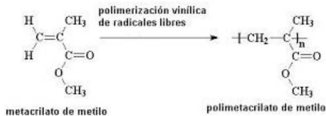
Figura 5: Estructura química de polimetacrilato de metilo
