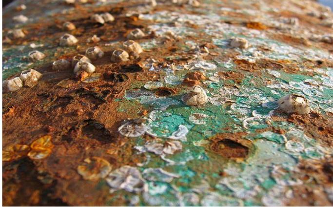
Figura 36: Corrosión del metal en estado terminal
