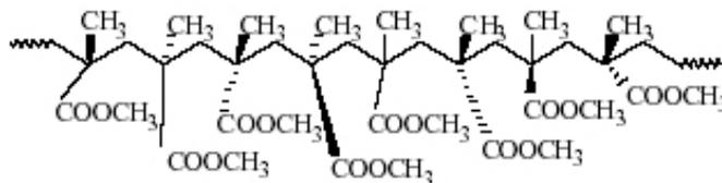
Figura 6: Estructura química de polimetacrilato de metilo
