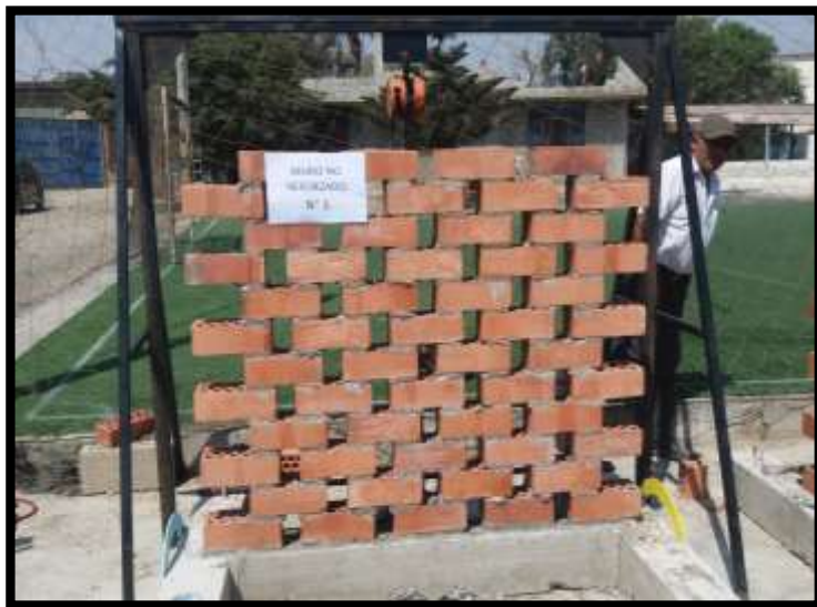
Fig. 2.42. Pórtico anclado para ejecutar el ensayo.
