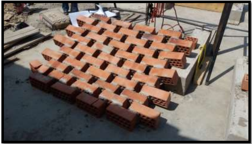
Fig. 2.43. Colapso de Muro Reforzado.
