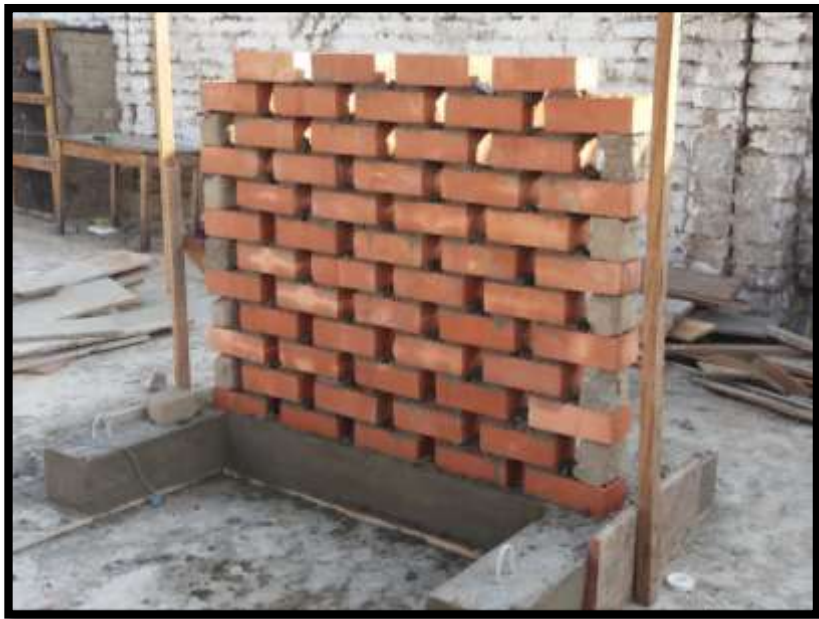
Fig. 2.34. Muro No Reforzado.
