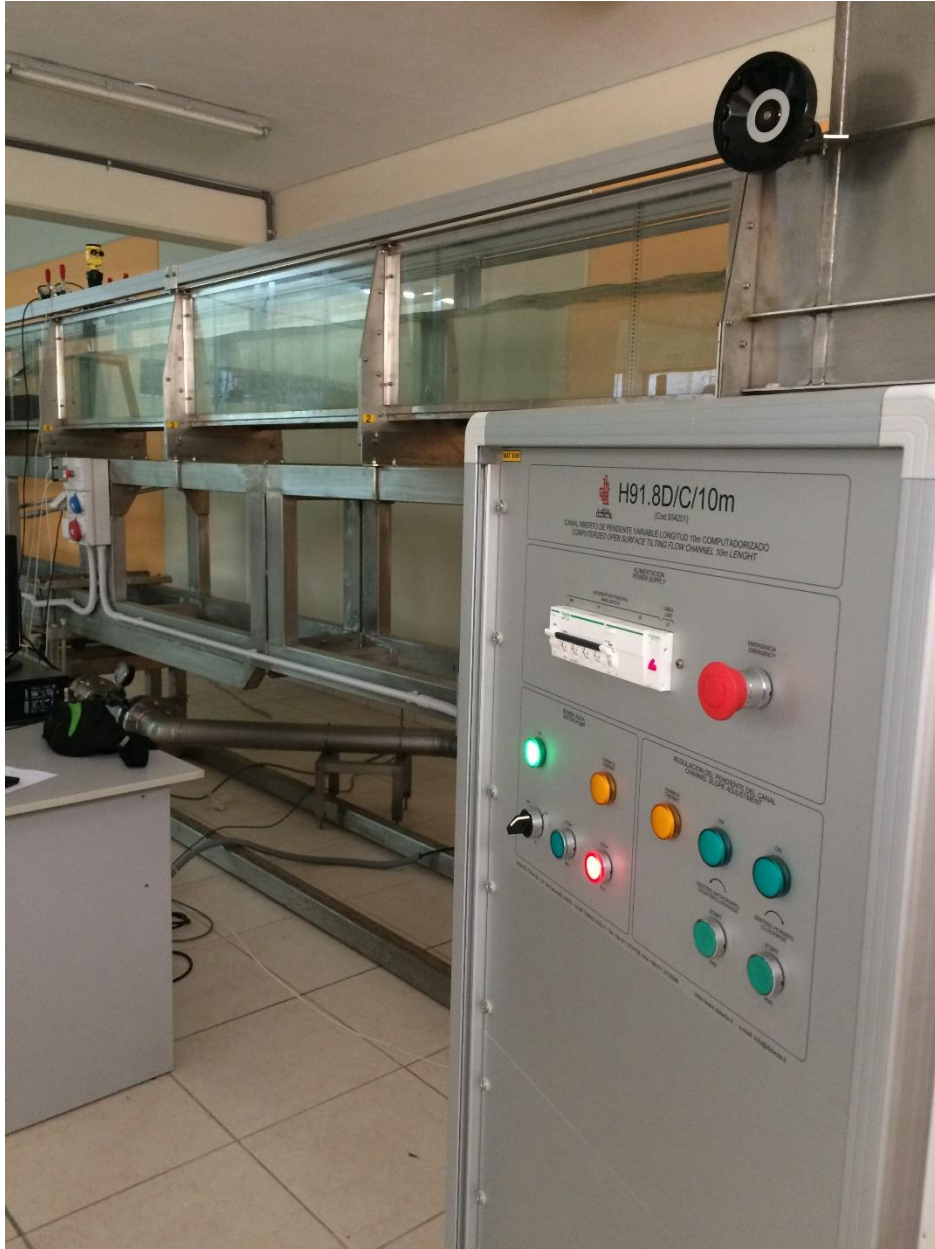
Fotografía N° 05 : Vista del Canal de Pendiente variable del Laboratorio de Hidráulica de la Universidad Privada Antenor Orrego de Trujillo.
