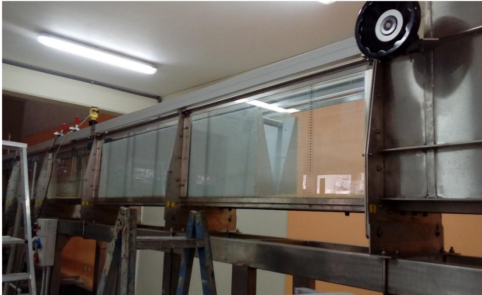
Fotografía N° 07 : Vista de Canal triangular de 2 metros de longitud, en el interior del canal rectangular de pendiente variable.
