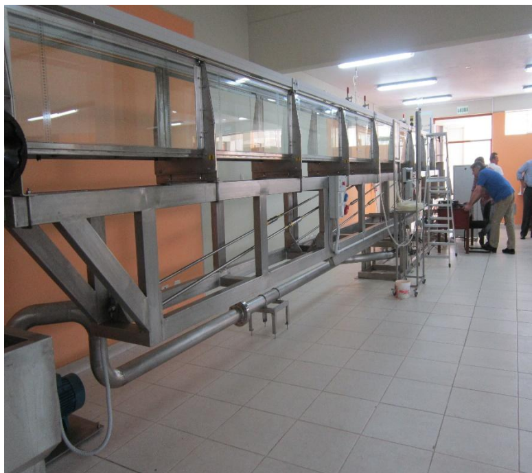
Fotografía N° 1: Vista de Canal Abierto de pendiente variable computarizado, longitud 10 mts; del Laboratorio de Hidráulica de la UPAO.
