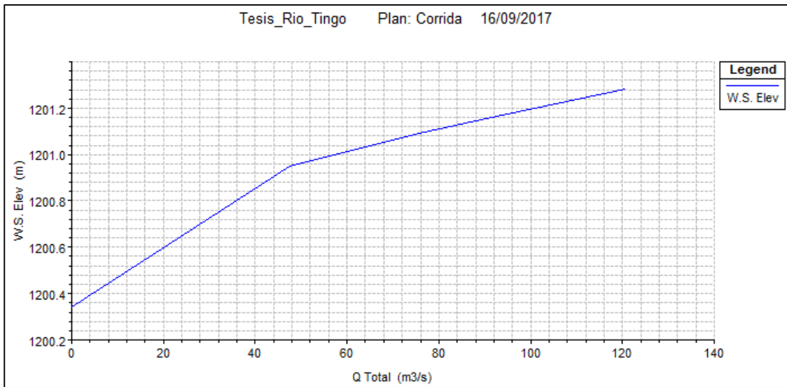
Fig. N°57: Grafica de curva de tirante medio vs caudal de diseño.
