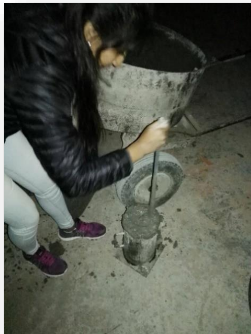
Imagen N° 49. Probeta de concreto.
