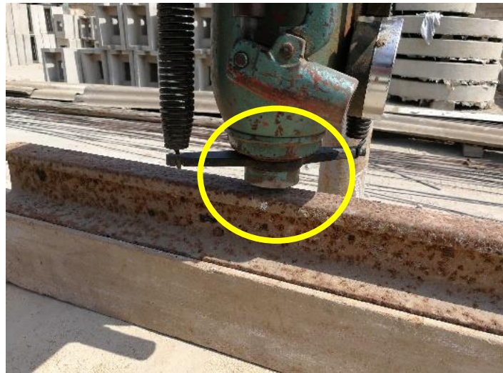
Imagen N° 61. Conexión directa entre la gata hidráulica con el riel de acero, para distribuir la carga de manera equivalente a lo largo de la losa.
