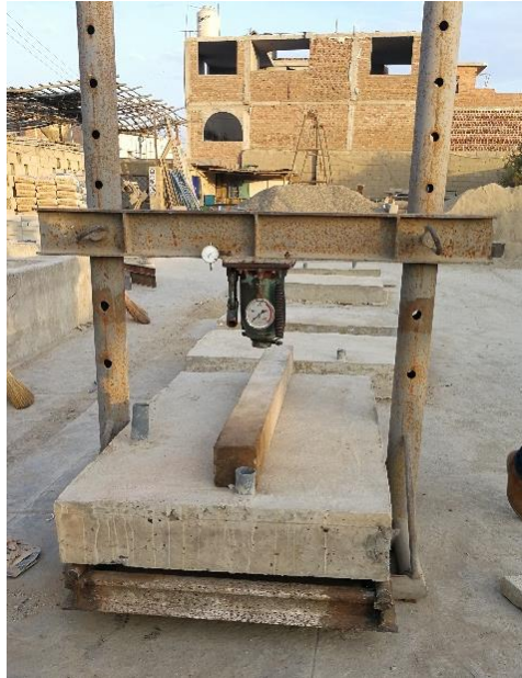
Imagen N° 59. Logramos observar a la losa ubicada en el centro del equipo, y a su vez logramos apreciar la gata hidráulica junto al deformímetro.
