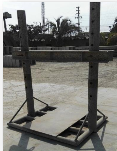
Imagen N° 05. Fotografía del marco de carga
