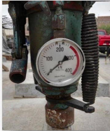
Imagen N° 04. Fotografía del gato hidráulico utilizado en el ensayo.
