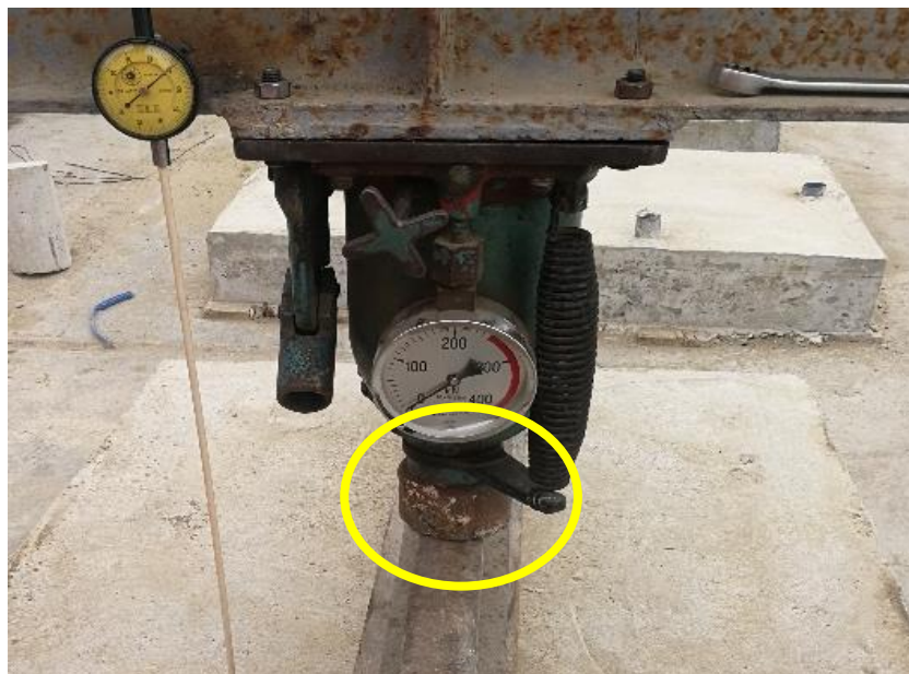
Imagen N° 62. Conexión mediante una pieza de acero entre la gata hidráulica con el riel de acero, para distribuir la carga de manera equivalente a lo largo de la losa.
