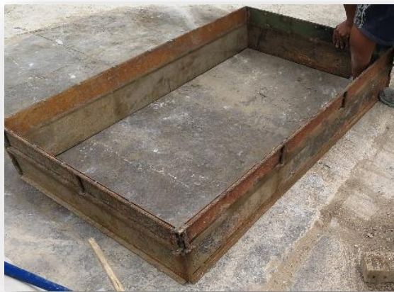
Imagen N° 10. Fotografía del molde de metal usado para las probetas de losas aligeradas.
