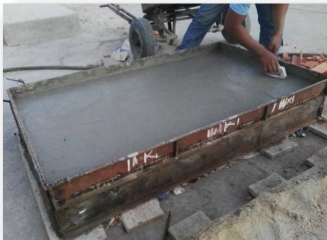
Imagen N° 44. Se pasó el frotacho para obtener una superficie con acabado liso en la probeta.
