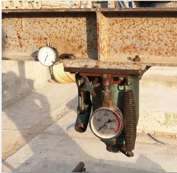
Imagen N° 53. Incorporación del deformímetro a la maquinaria mediante soldadura, para mejor rigidez.
