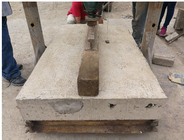
Imagen N° 60. Se aprecia todos los elementos ubicados de manera correcta y se inicia el ensayo.
