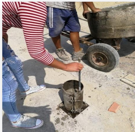
Imagen N° 47. Probeta de concreto a 1/3 de su longitud.
