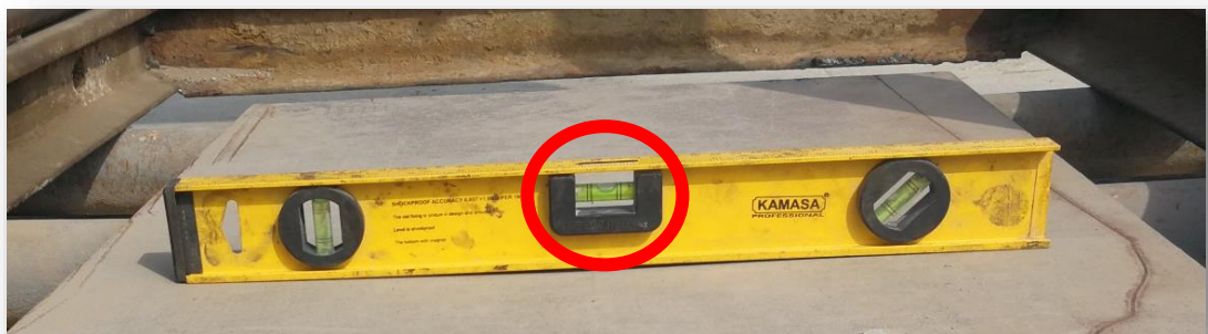
Imagen N° 51. Se utilizó una regla de nivel para corroborar que el equipo a usar estuviera correctamente ubicado.
