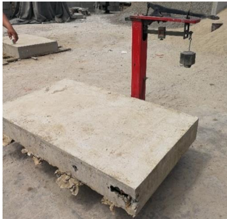
Imagen N° 55. Una vez colocada la losa en el centro de la balanza se procedía a medir el peso de la misma.
