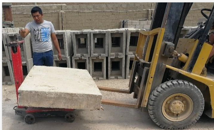
Imagen N° 54. Ubicación de la losa sobre la balanza con ayuda del montacargas.
