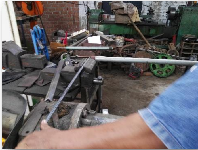
Imagen N° 15. Fotografía del doblado del fierro para las viguetas.
