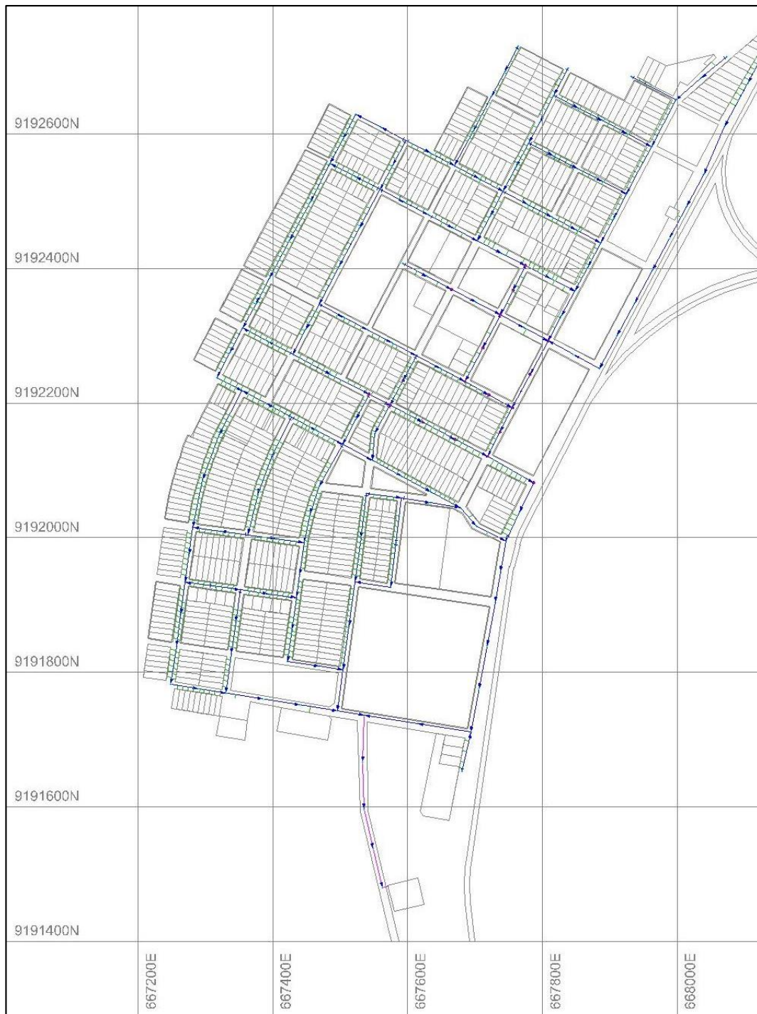
Figura n° 4. 3: Esquema general de la red de alcantarillado
