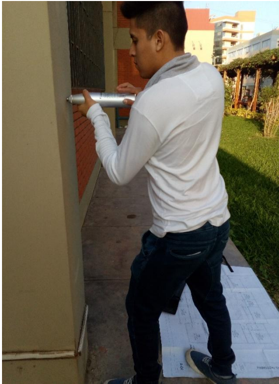
Foto F-1: Ensayo de Esclerometría en el Pabellón “D”
