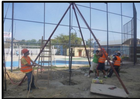
FOTO 1: Vista del Ensayo de Penetración Estándar (SPT), realizada por SL DE INGENIERIA EIRL en el Campus de la UPAO
