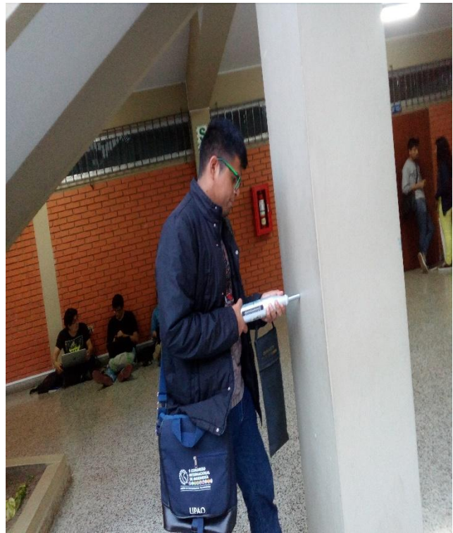
Foto F-1: Ensayo de Esclerometría en el Pabellón “D”
