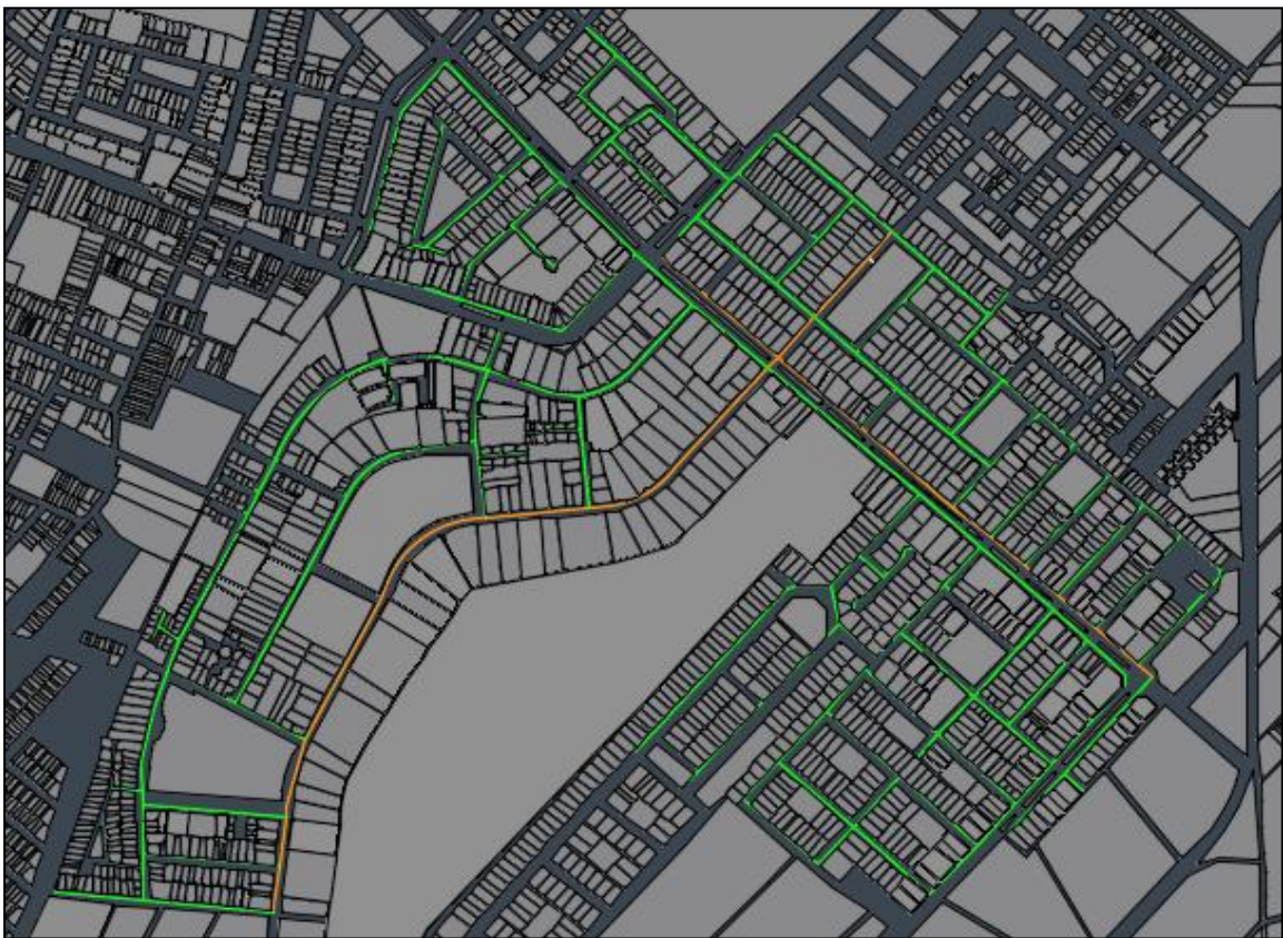
IMAGEN N° 10: Red de agua potable sectorizada – Urb. El Golf y aledaños
