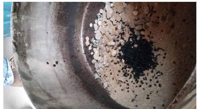
PREPARACION DE LAS BIQUETAS MODIFICADAS COJ PARTICULAS DE CAUCHO
