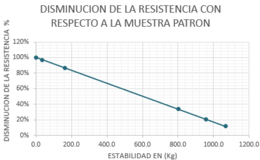
Fig. 30: Grafica de la disminución de la resistencia con respecto a la muestra patrón
