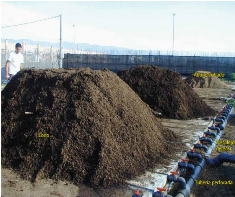
Figura 2.37 Montículos en pilas para el composteo de lodos.
