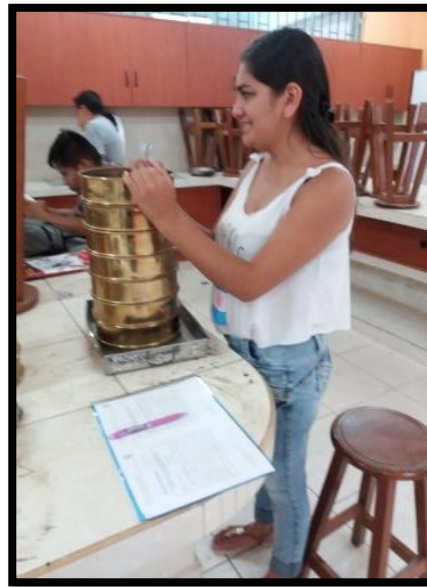
Figura N° 06 Ilustración del tamizado de los agregados
