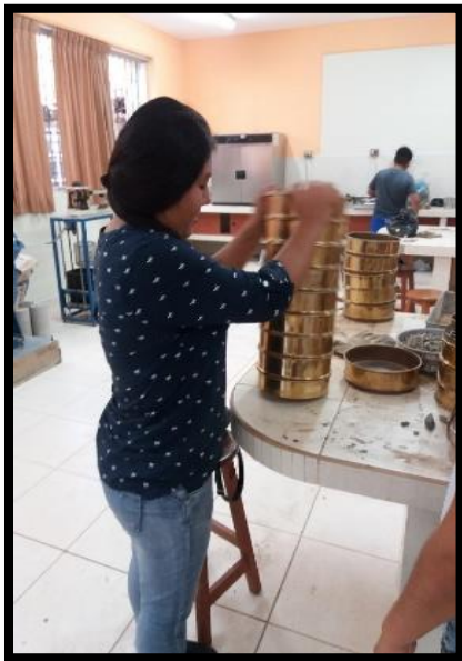
Figura N° 06 Ilustración del tamizado de los agregados
