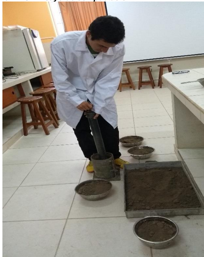
Foto N°15: Ensayo de compactación
