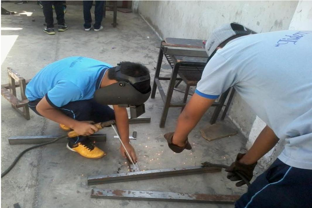
Ensamblando las piezas a través de soldadura por arco eléctrico.
