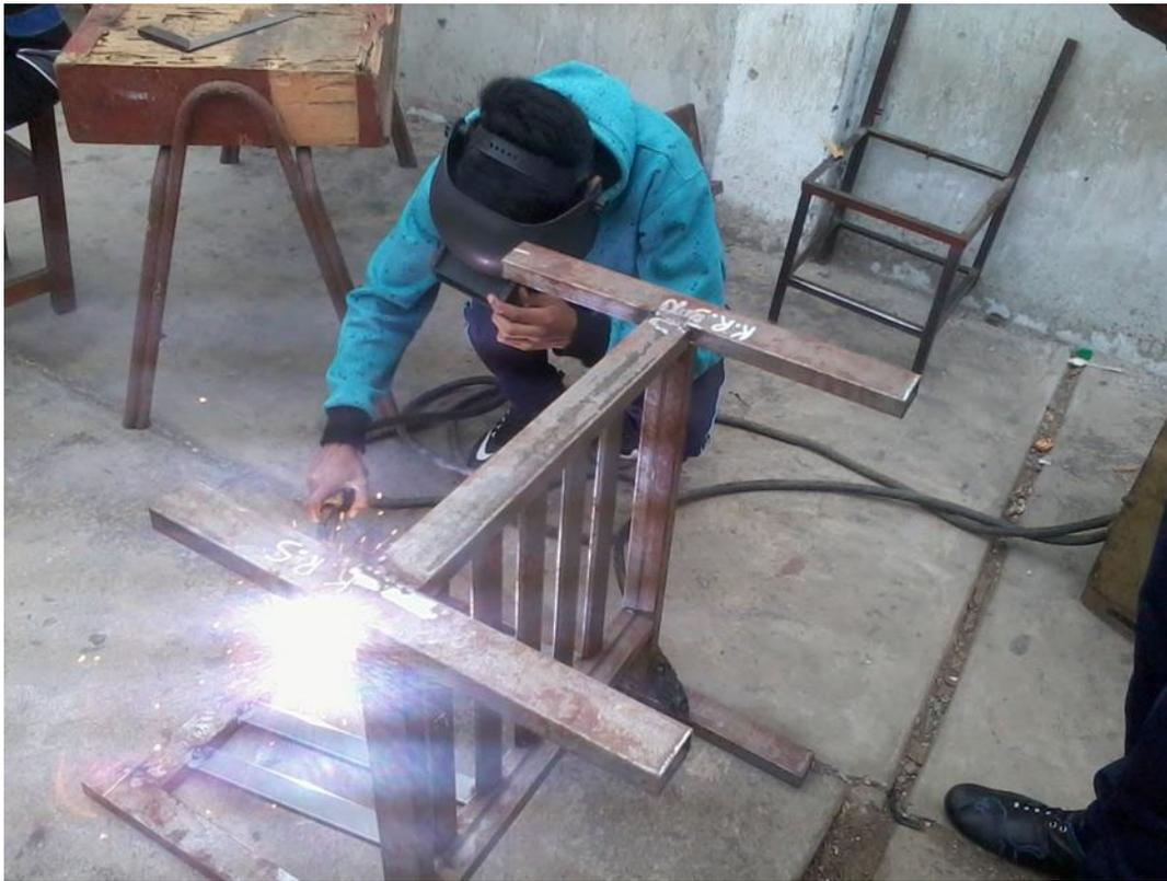
Soldando por arco eléctrico el espaldar del sillón.
