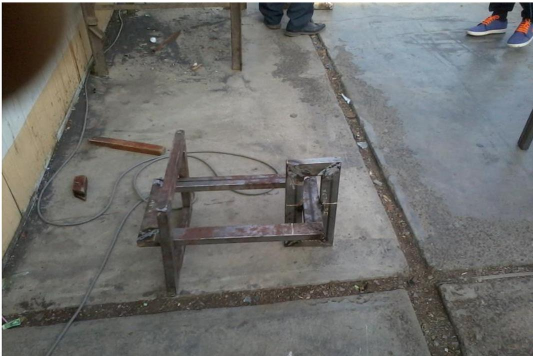
Terminando de ensamblar la mesa de centro a través de soldadura por arco eléctrico.
