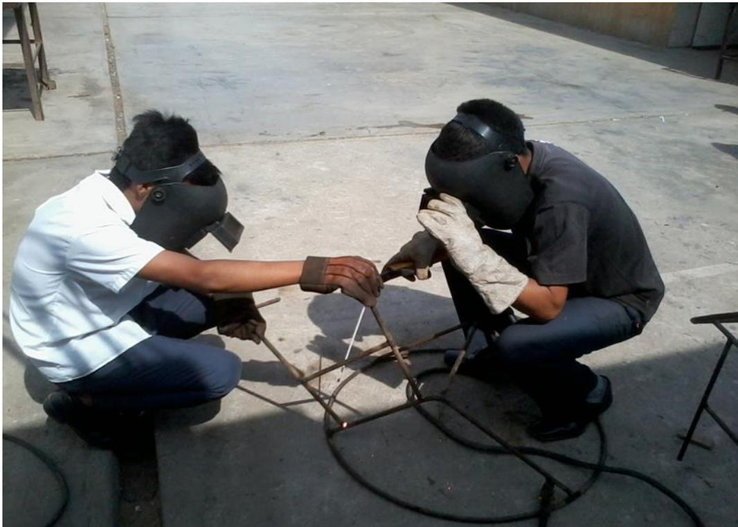
Ensamblando las piezas de un sillón simple a través de soldadura por arco eléctrico.
