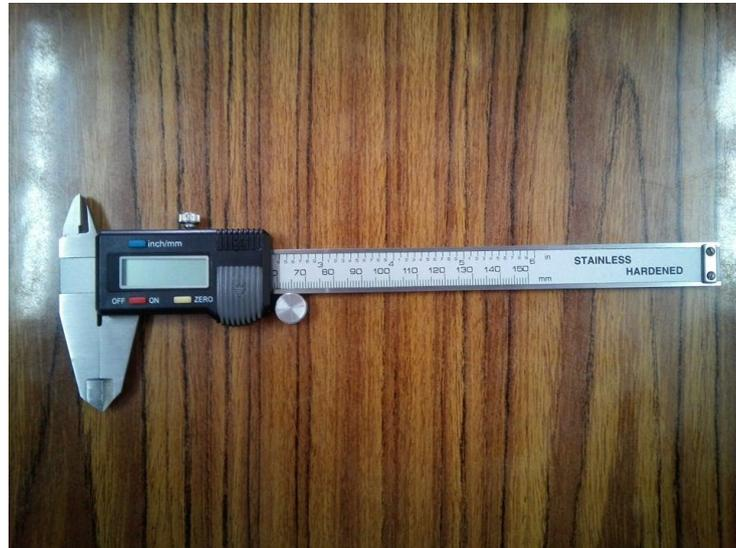
Figura m. Vernier digital del laboratorio de Física 01 de la UPAO.
