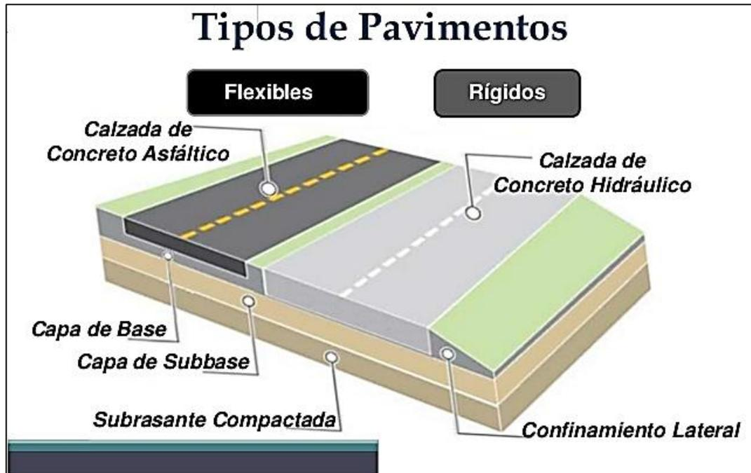
Las vías de la provincia de Otuzco deberían ser construidas con pavimento rígido o flexible con la finalidad de que soporten el clima agresivo de la sierra como son sus lluvias tormentosas. **Fuente: Ing° Eliezer Chirinos C. Métodos de Diseño de Pavimento.**
