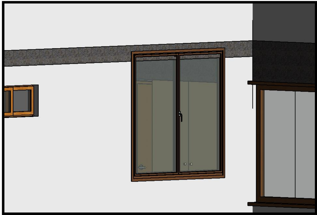
Figura 43. Ventana en la que no se consideró la viga para su altura.
