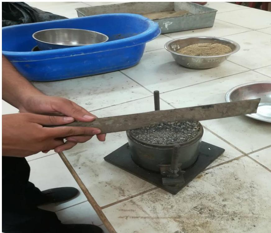
Medir la masa del recipiente junto con el agregado.
