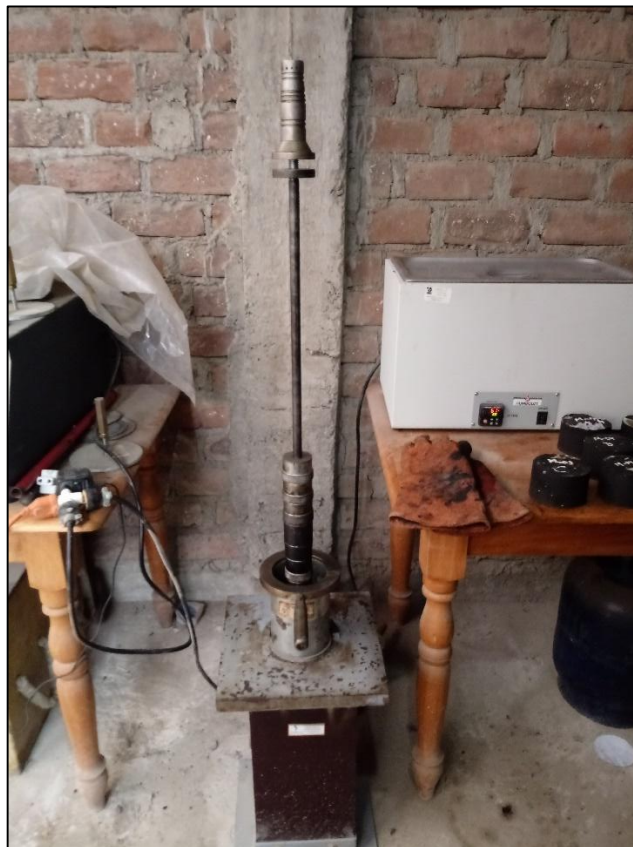
Fotografía: Martillo de compactación de los especímenes.
