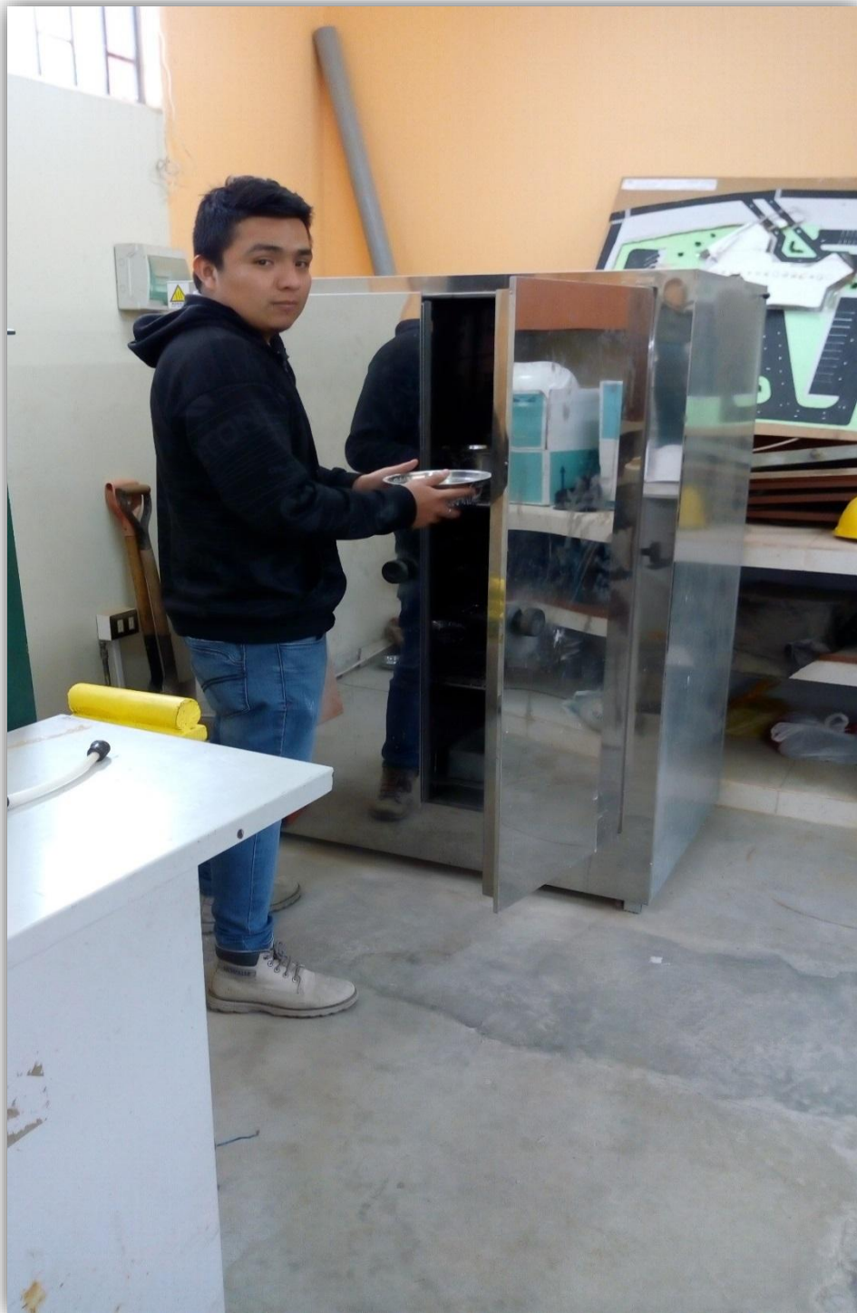
TOMA 04: COLOCACION DE MUESTRA EN EL HORNO PARA DETERMINAR EL CONTENIDO DE HUMEDAD. EQUIPO EMPLEADO: HORNO ELECTRICO DIGITAL.
