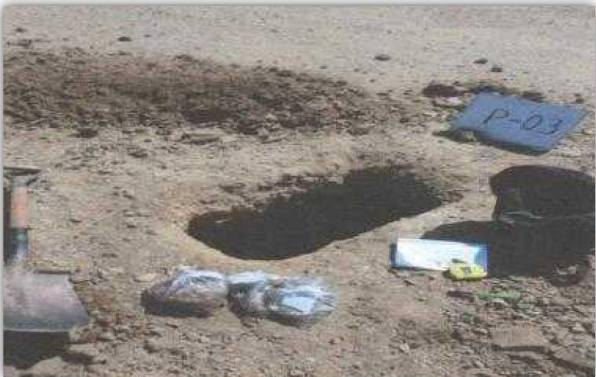
TOMA 06: EXCAVACION DE CALICATA N° 03 PARA EXTRAER MUESTRAS DEL ESTRADO. HERRAMIENTAS EMPLEADAS: PALANA TIPO CUCHARA + BOLSA HERMETICA.
