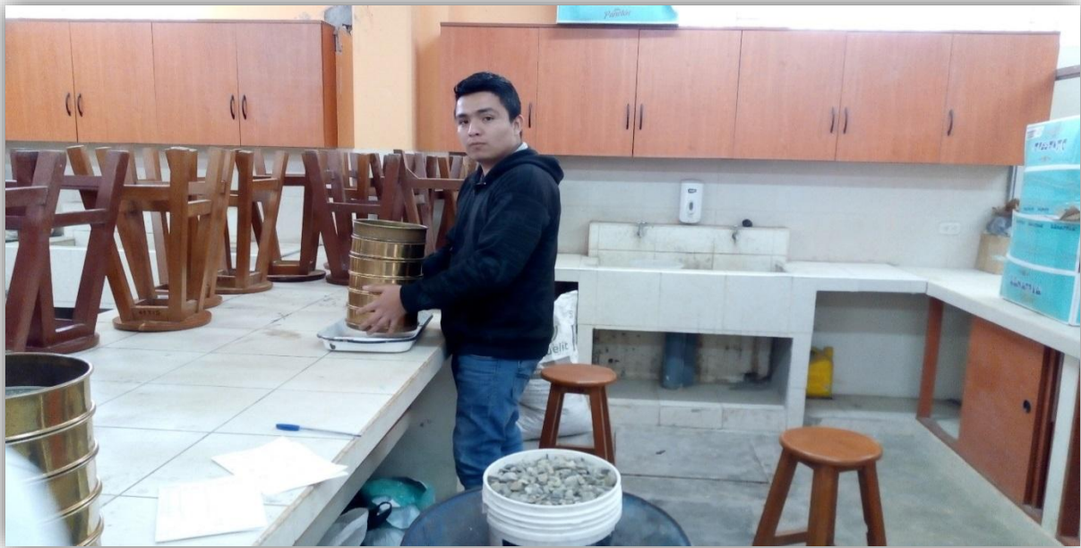
TOMA 02: ZARANDEADO DE LA MUESTRA PARA EL ANALISIS GRANULOMETRICO EQUIPO EMPLEADO: JUEGO DE TAMIZES METALICOS.
