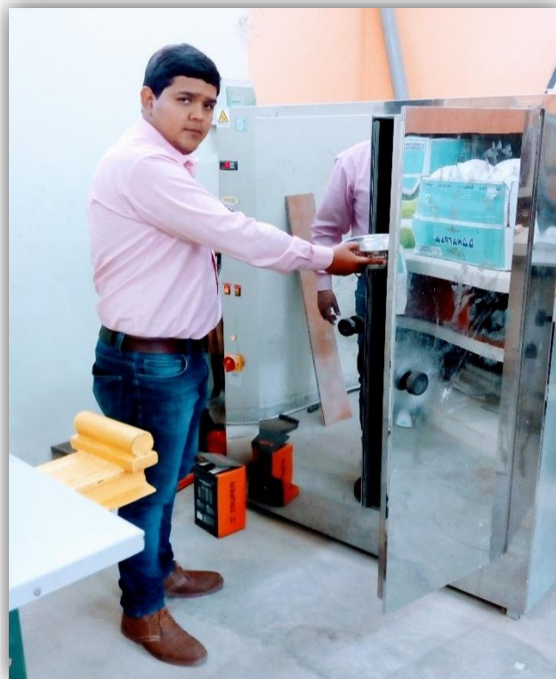
TOMA 03: COLOCACION DE MUESTRA EN EL HORNO PARA DETERMINAR EL CONTENIDO DE HUMEDAD. EQUIPO EMPLEADO: HORNO ELECTRICO DIGITAL.
